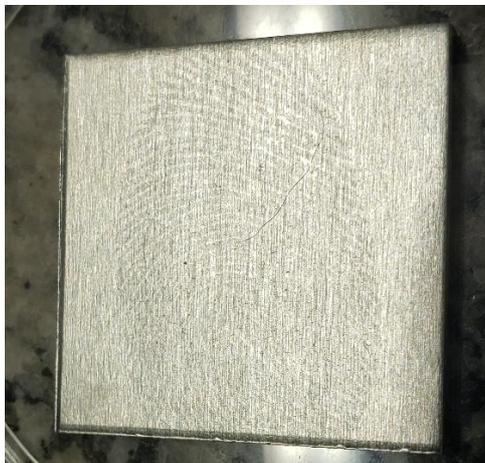
Figura 50. Imagem de impressão digital dopada com solução de MA  $5,0 \times 10^{-2}$  mol/L depositada sobre uma lâmina de Alumínio de  $25 \times 25$  mm.
