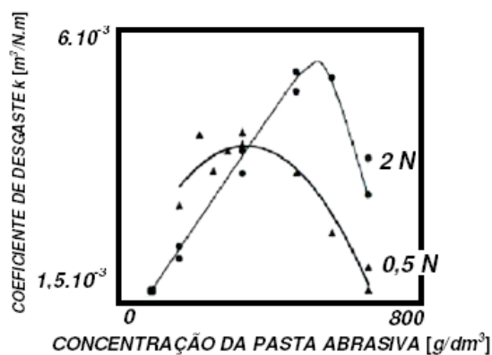
Figura 3.14: Variação do coeficiente de desgaste em função da concentração da pasta abrasiva para o POM. [94]
