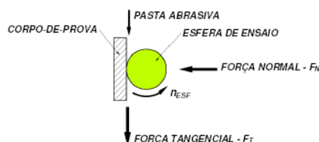
Figura 3.3: Princípio de funcionamento do ensaio de desgaste micro-abrasivo por esfera fixa. [68]
