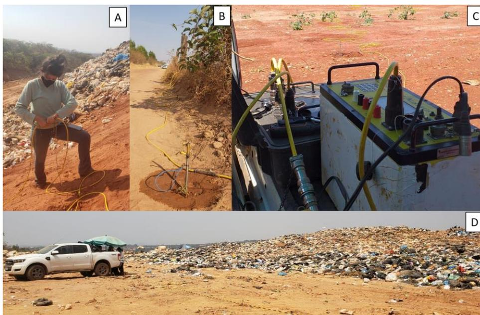
**Figura 5-6** Fotografias evidenciam a aquisição de dados de resistividade elétrica na área do Aterro Controlado de Caldas Novas. (A) Foto de operador conectando os cabos multieletródicos. (B) Foto detalha eletrodo conectado ao cabo multieletródico. (C) Detalhe do eletrorresistivímetro Supersting conectado ao computador de eletrodos (Switch box). (D) Foto confirma a equipe durante a aquisição de dados de resistividade elétrica.
