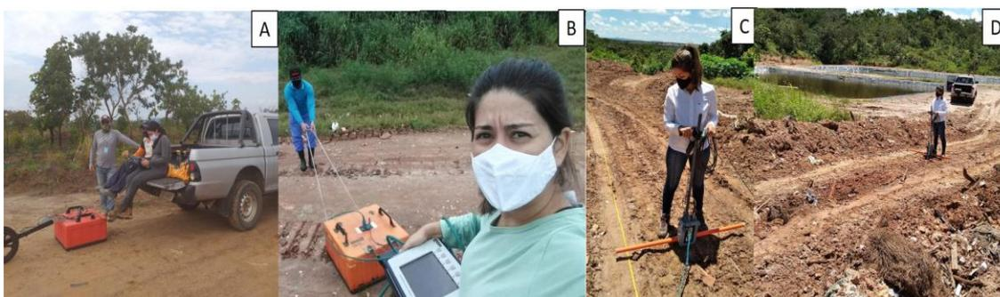
**Figura 5-3** Fotografias evidenciam a aquisição de dados de GPR na área do Aterro Controlado de Caldas Novas - GO. (A) e (B) Coleta de dados GPR com a técnica Common Offset com o equipamento SIR3000 e antenas blindadas de 200 MHz. (C) e (D) Aquisição de sondagem de velocidade (CMP) com antenas não blindadas de 80 MHz.
