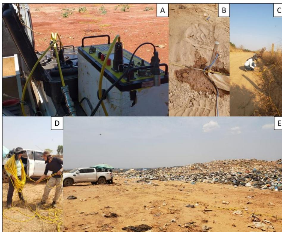
**Figura 4-3** Materiais usados para aquisição de campo. A) SuperSting conectado a cabos; B) Eletrodo de aço inoxidável conectado aos cabos; C) Montagem em linha; D) Cabos com 14 saídas cada; E) Monitoramento de Aquisição.
