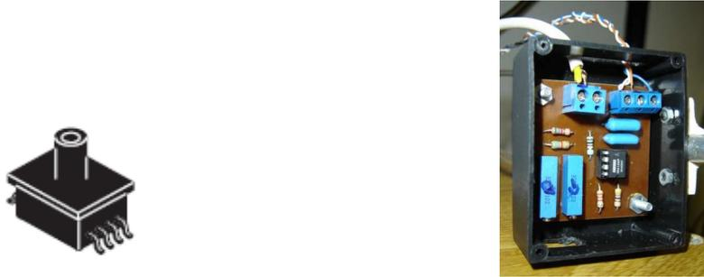
Figura 2.6 – a) Medição de nível: a) sensor de pressão, b) condicionamento dos circuitos do sensor de pressão
