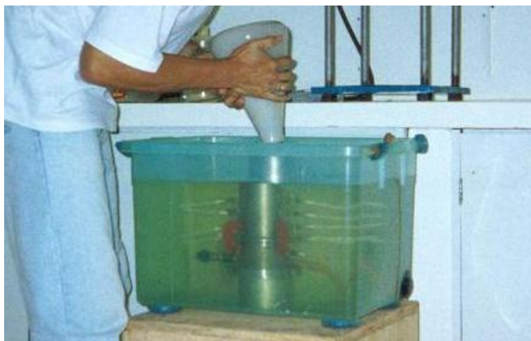
Figura 4.3 – Fase de preparação da amostra através da técnica da pluviação.
