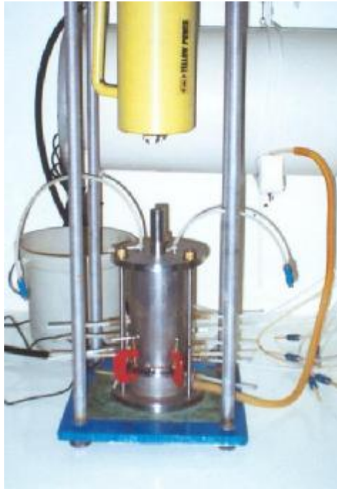
Figura 4.7 – Fechamento do permeâmetro e conexão dos piezômetros.
