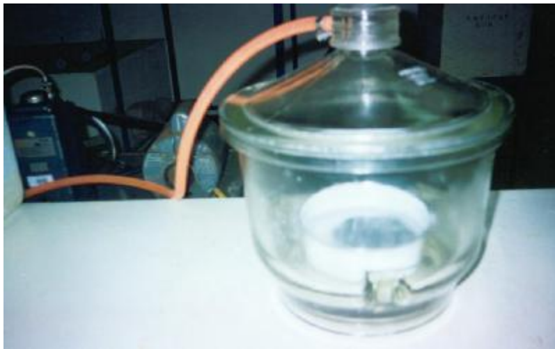
Figura 4.1 – Saturação do geotêxtil através de vácuo.
