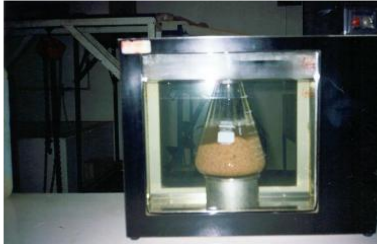
Figura 4.2 – Saturação do solo através de fervura.
