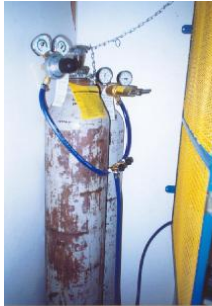
Figura 3.6 – Cilindros de nitrogênio para aplicação de cargas.
