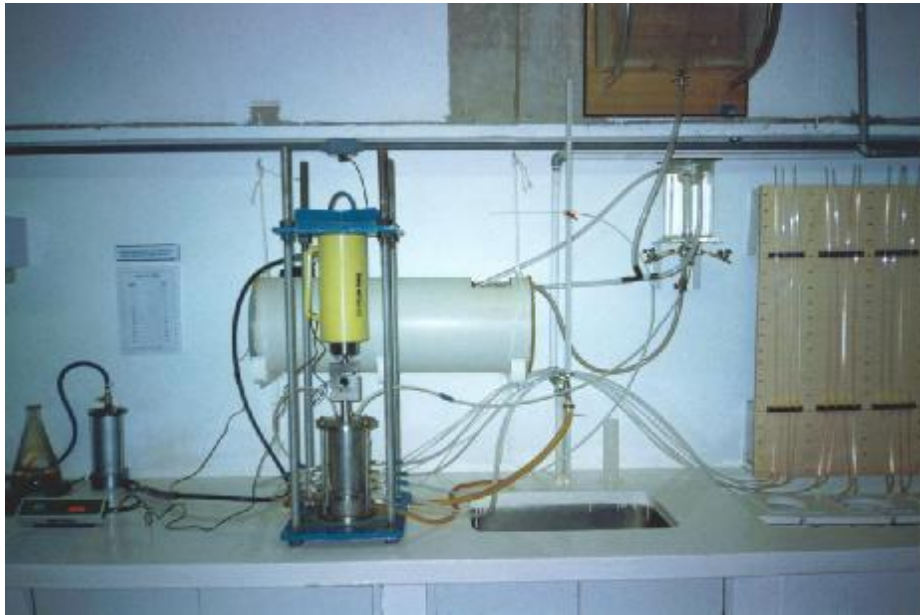
Figura 4.8 – Vista geral do equipamento de filtração sob tensão em operação.
