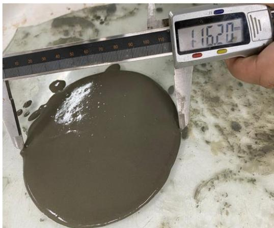
Figura 48: Ensaio de mini slump de amostra de pasta de cimento Portland (P-NSFA 4).
