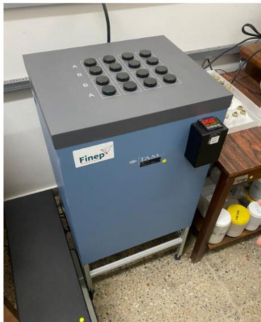
Figura 56: Calorímetro de condução isotérmica Termométrica TAM AIR de oito canais com controle de temperatura.
