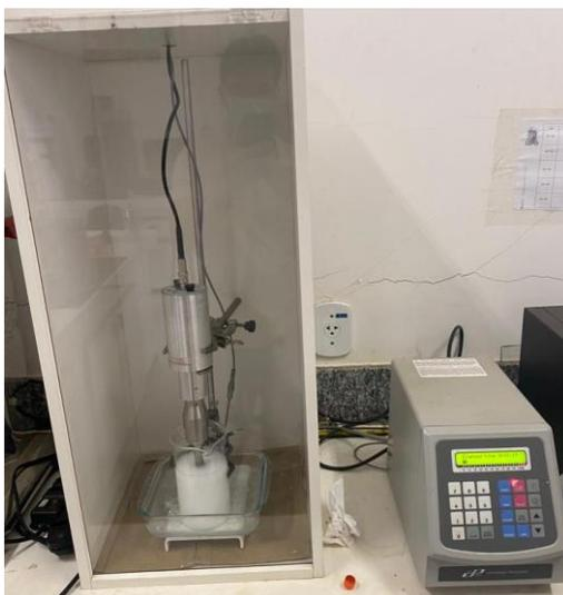
Figura 40: Processo de ultrassonificação das NS e NSFA's.
