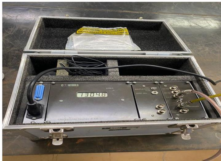
Figura 54: Equipamento de ultrassom utilizado para ensaio de tempo zero.
