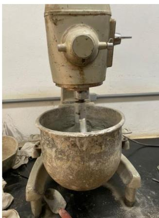
Figura 49: Misturador utilizado para mistura do microconcreto.
