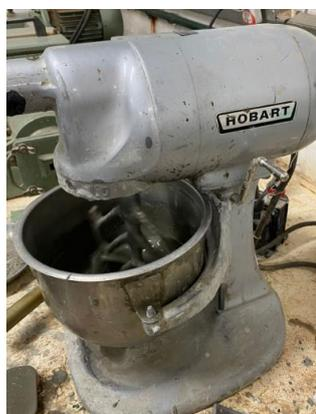
Figura 47: Misturador utilizado para mistura das pastas de Cimento Portland.
