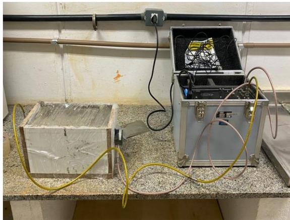
Figura 55: Forma utilizada e ligação dos transmissores do aparelho de ultrassom na amostra de Microconcreto.
