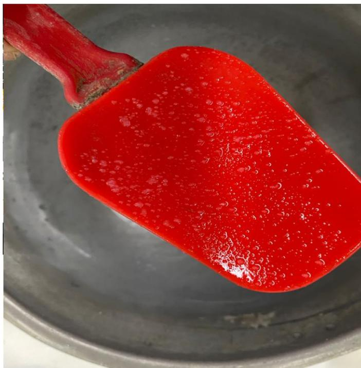
Figura 51: Formação de pequenas partículas de gel na mistura dos componentes líquidos para a amostra P-NSFA 8.
