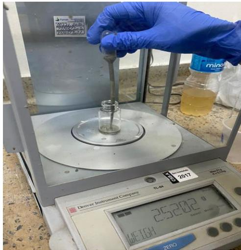
Figura 58: Introdução da pasta pronta na ampola e pesagem de sua quantidade.
