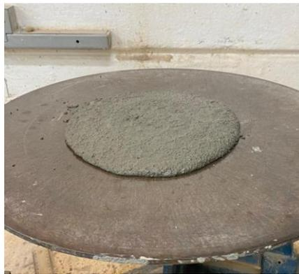
Figura 50: Amostras de microconcreto na mesa de consistência - índice de consistência.
