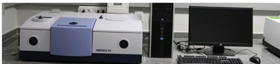
Figura 45: equipamento Espectrômetro infravermelho Bruker Vertex-70 (CRTI, 2022)
