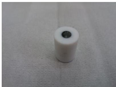
**Figura 3.** Eletrodo de trabalho utilizado de carbono reticulado vítreo revestido em Teflon
