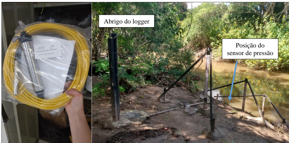
Figura 4.12 - Linígrafo da marca Global Water utilizado— - à esquerda— - e localização do sensor e logger do linígrafo junto às réguas linimétrica— - à direita.
