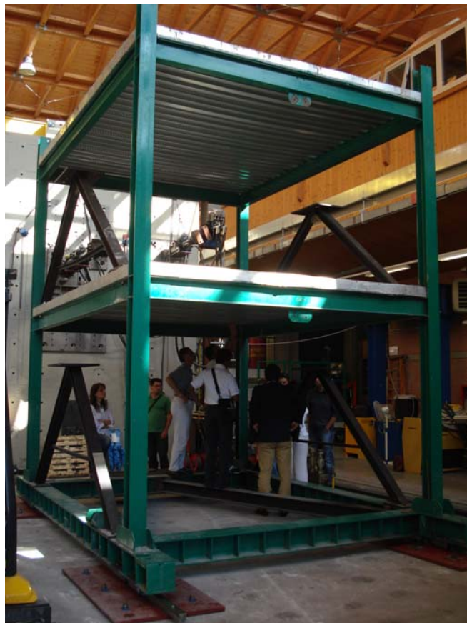
Figura 8.1 – Modelo experimental do pórtico.
