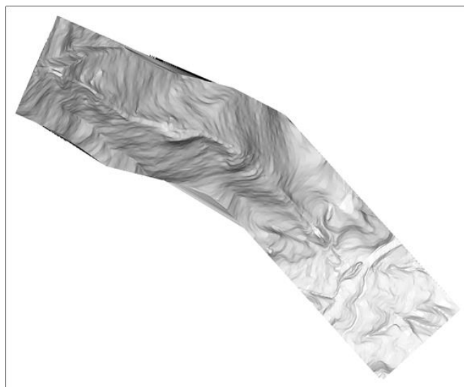
Figura 4.9 – Modelo digital de declividades gerado a partir do modelo digital de elevação do terreno.
