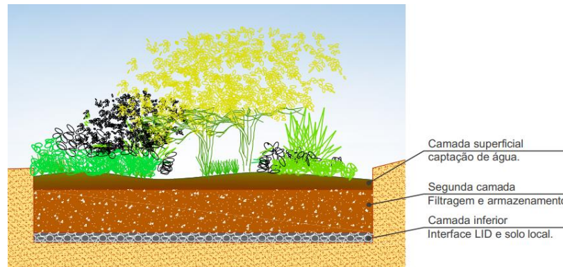
Figura 01: Representação esquemática de um jardim de chuva
