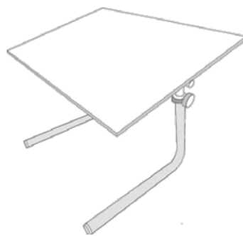
Figura 8 – Esboço mesa de estudo modular com tampo inclinável e regulagem de altura. Fonte: Alves (2011, p. 56).
