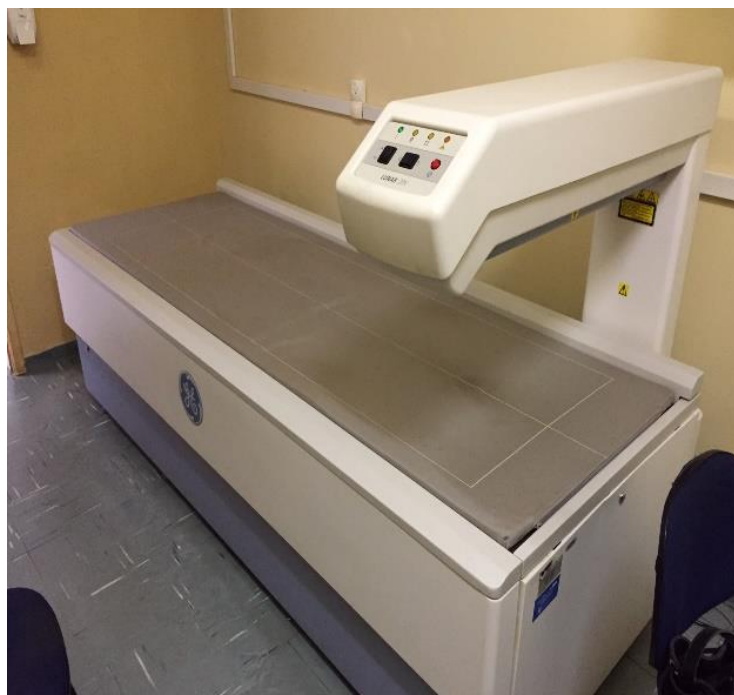
Figura 5 – Fotografia do aparelho para densitometria óssea por DXA Lunar DPX NT localizado no Serviço de Densitometria Óssea do Hospital Universitário de Brasília.
