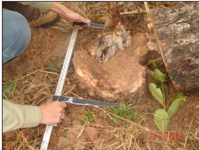
Figura 4.2. Medição do diâmetro do toco para o método de Huber.
