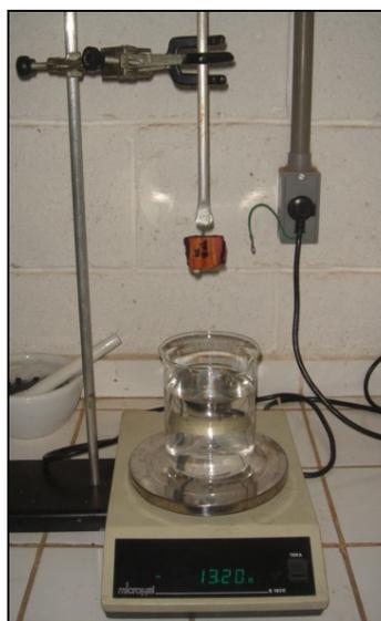
Figura 4.7. Volumetria dos corpos de prova.
