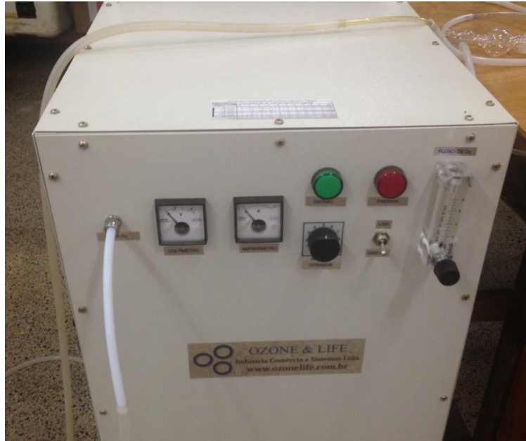
Figura 1. Gerador de Ozônio Modelo O&L 3.0-O2 RM, da Ozone & Life, São José dos Campos, Brasil. Acervo pessoal.
