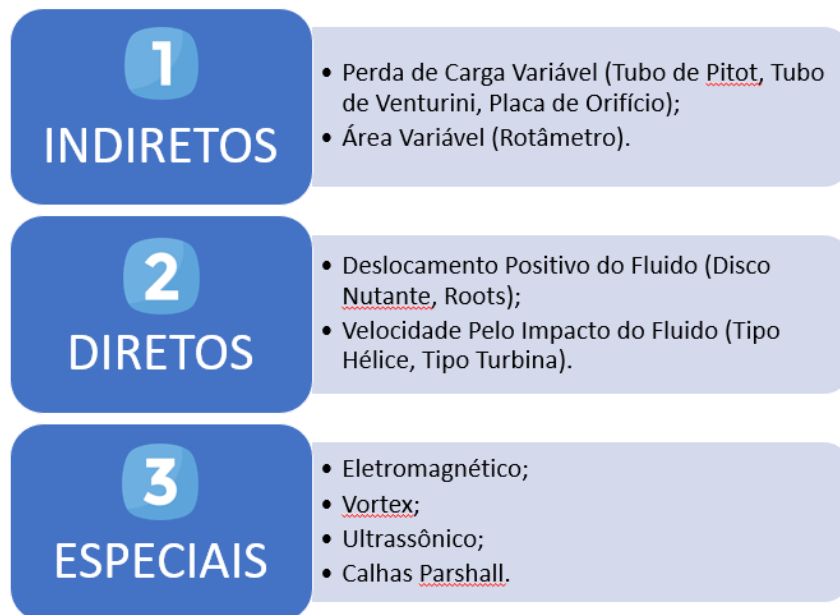
Figura 07 – Tipos de medidores de vazão. Adaptado de USP (2017).
