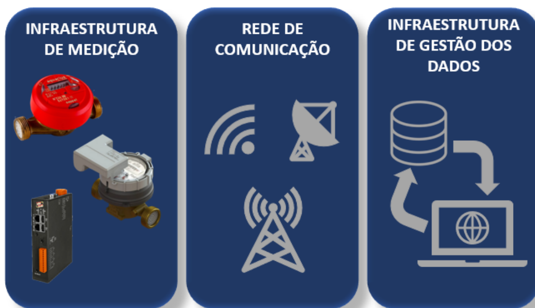
Figura 08 - Sistema de leitura remota para apuração do consumo de água. Adaptado de Lima e Navas (2012).
