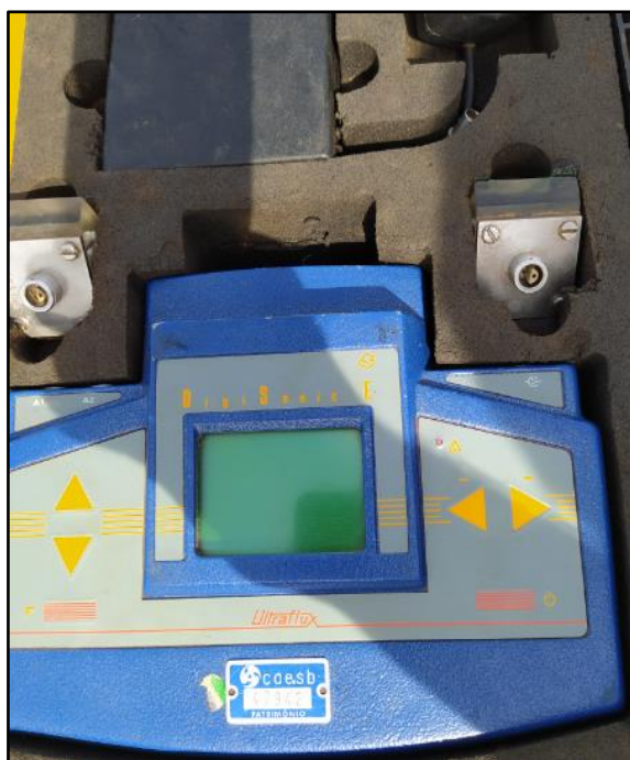
Figura 20 – Medidor de vazão utilizado.
