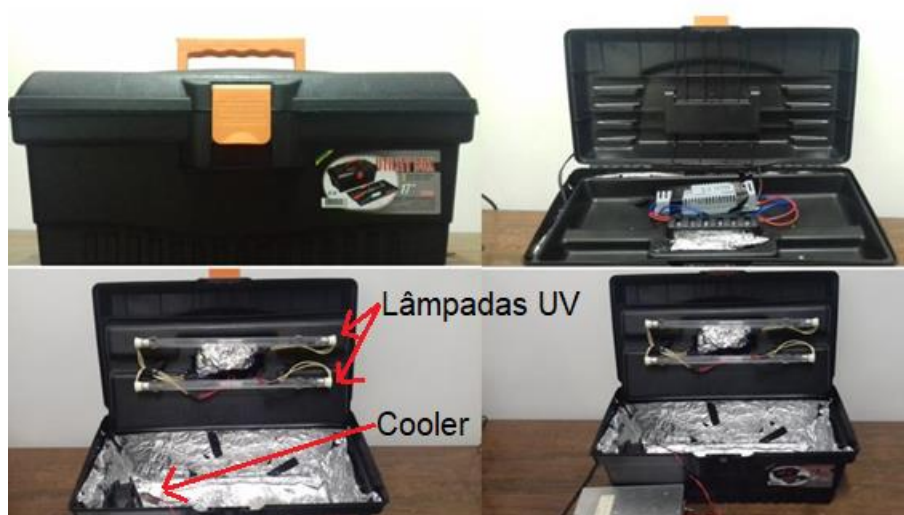
Figura 19. Câmara UV para o preparo da amostras, contendo duas lâmpadas UV (254 nm, 8 W, Osram) e um sistema de ventilação. [71]
