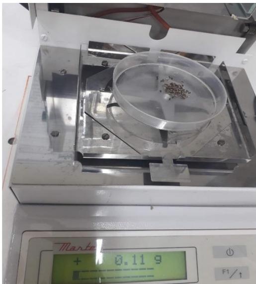
**Figura 3:** Balança usada para pesagem das repetições de sementes de amica na determinação do peso de mil sementes e peso da secagem.
