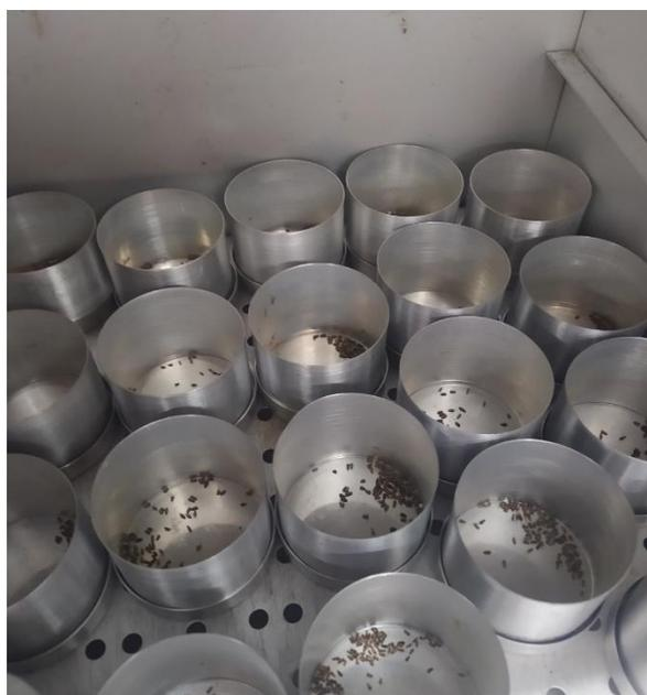
**Figura 2:** Sementes de arnica acondicionadas em recipientes de alumínio para a determinação de umidade em estufa a 105°C.
