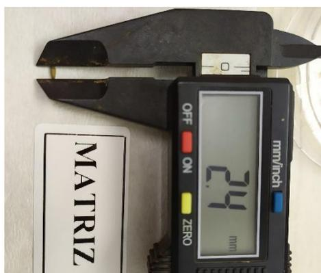
**Figura 6 :** Paquímetro digital empregado na determinação do tamanho das sementes de amica.
