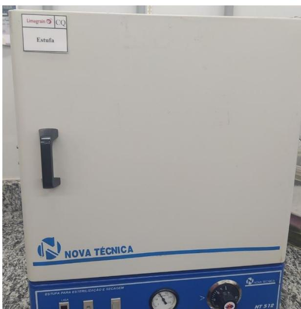
**Figura 1:** Estufa de secagem empregada na determinação da umidade das sementes de arnica.
