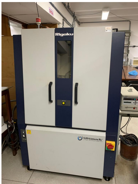
Figura 3-15. Equipamento RIGAKU para ensaio de difratometria de raios -X
