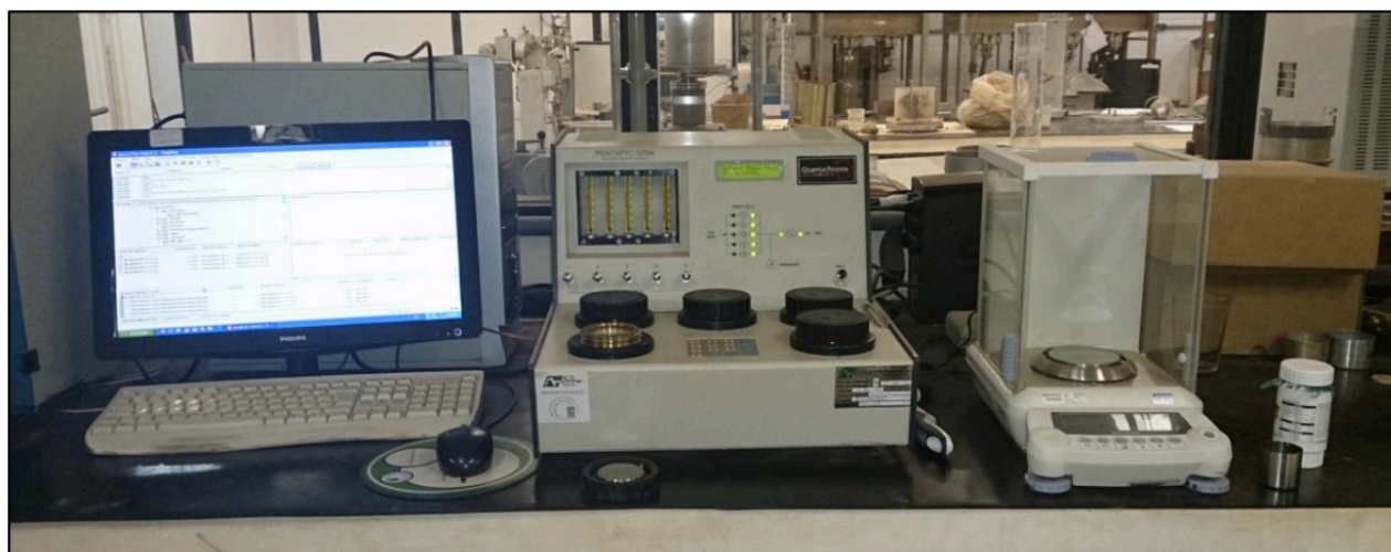
Figura 3-5. Analisador automático de densidade, modelo PENTAPYC 5200e.
