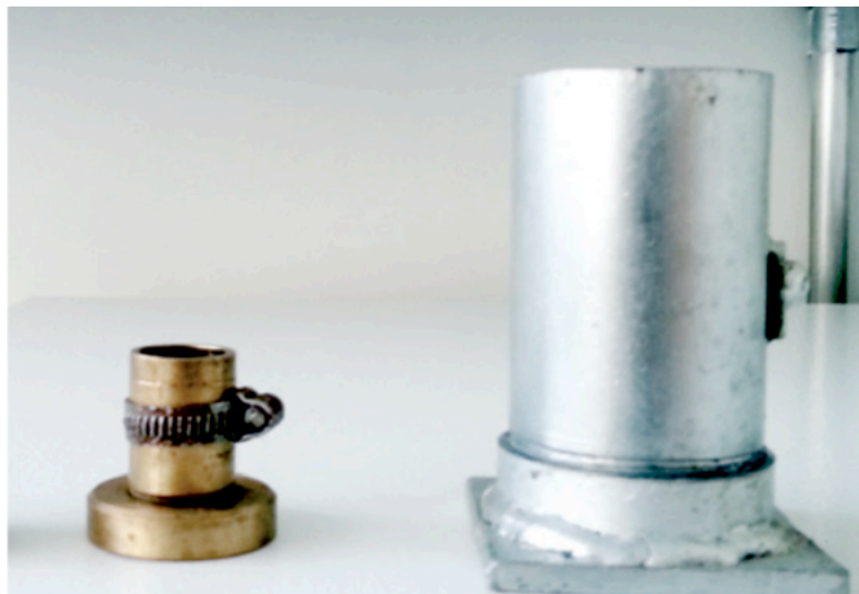
Figura 2-7. Moldes para corpos de prova nos tamanhos de 20x40 mm e 50x100 mm.
