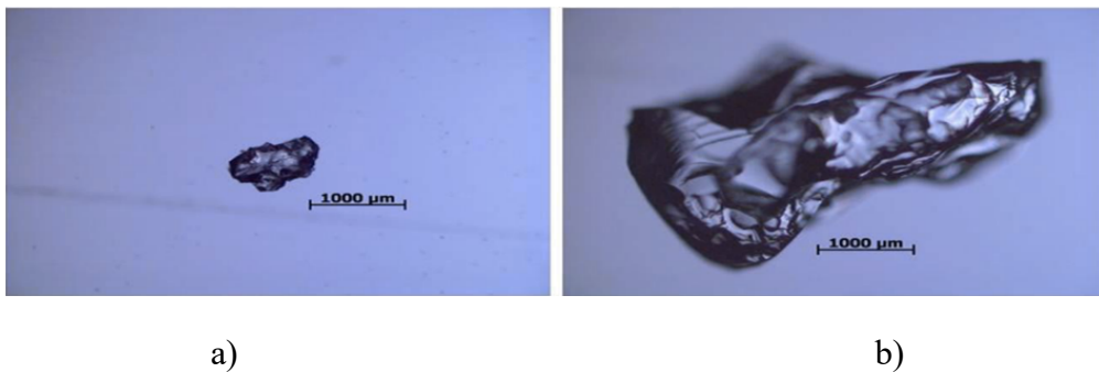
Figura 2-19. Capacidade de absorção de um SAP: a) estado seco, b) estado saturado.
