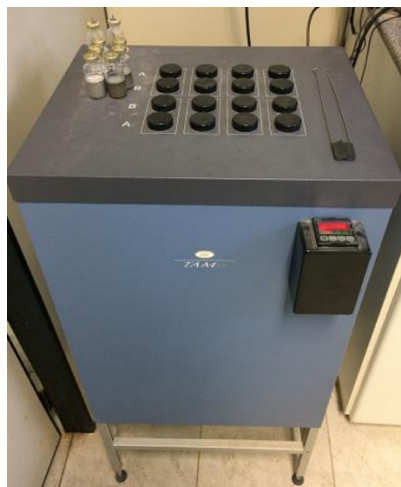
Figura 3-16. Equipamento Thermometric AB da TAM Air (TA instruments).
