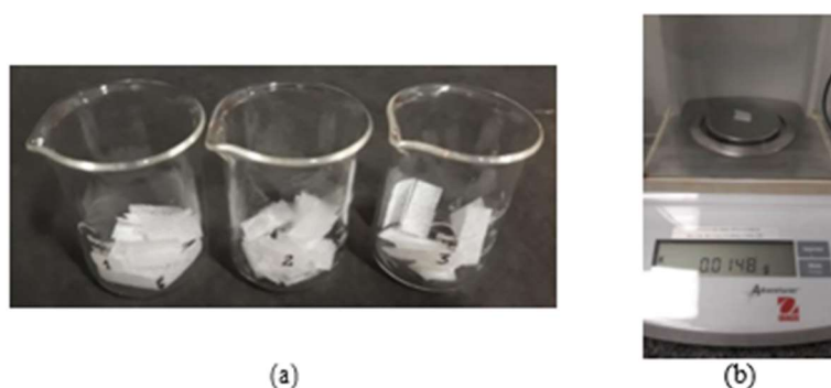
Figura 4. Detalhe da preparação para gramatura: a) separação das três camadas, b) medição na balança de precisão.
