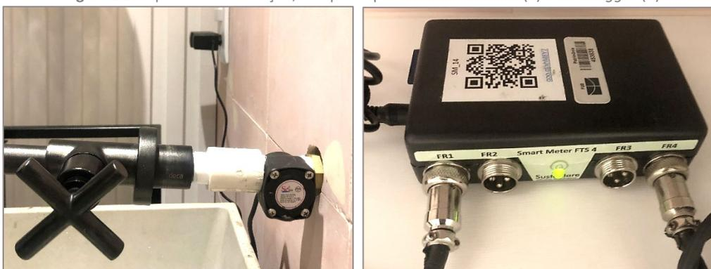
Os medidores utilizados neste estudo foram aferidos e calibrados previamente, identificando-se o erro máximo de 10% para menos, para todas as faixas de vazão, e um erro na precisão de tempo dos eventos registrados no *data logger* de ordem de mais ou menos 1 segundo (SANT'ANA, 2018).
