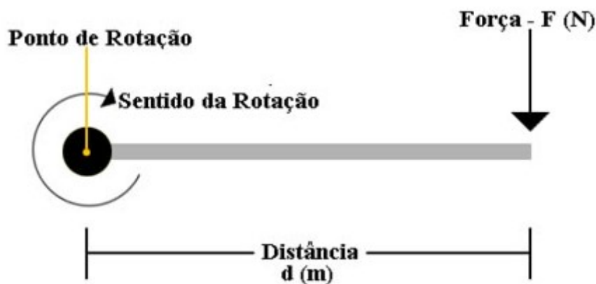
Figura 5.6 – A alavanca será rotacionada em virtude da aplicação da força F.
