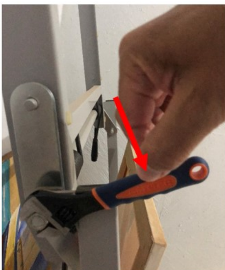
Figura 3.9 – Aplicação de força no meio da chave. Fonte: Elaboração própria (2021).
