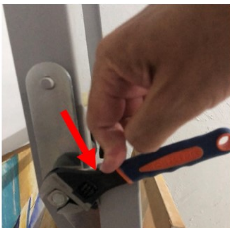
Figura 3.10 – Aplicação de força próximo ao parafuso. Fonte: Elaboração própria (2021).
