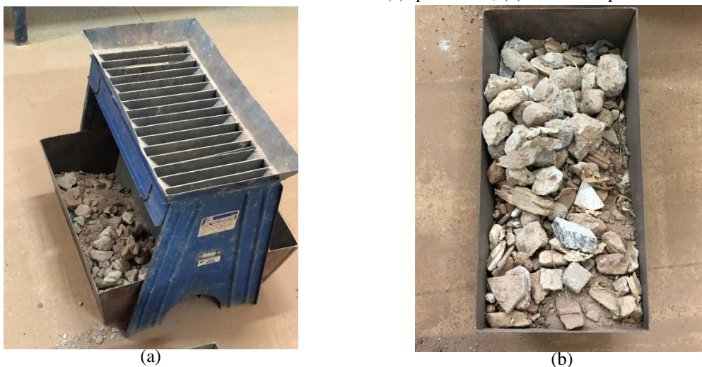
Figura 23 – Preparação do material fornecido pela empresa ATTR Martins Ambiental para realização dos ensaios no Laboratório do DER/DF: (a) quarteador; (b) amostra separada
