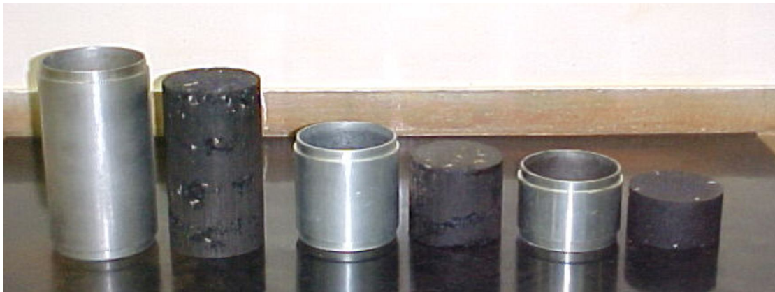
Figura 3.10: Corpos de prova extraídos após a compactação (Falcão, 2003).
