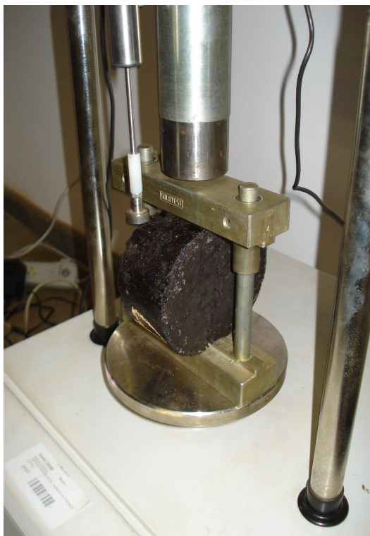
Figura 3.11: Ensaio de resistência à tração por compressão diametral.
