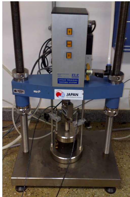
Figura 3.16 Prensa utilizada para realização do ensaio de fluência estática.
