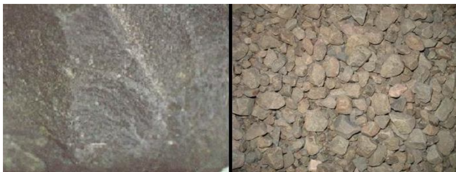
Figura 3.2: Novo agregado estudado- basalto.
