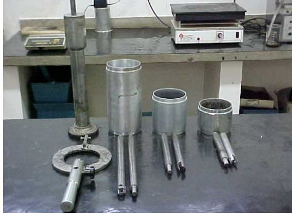
Figura 3.9: Cilindros metálicos e respectivos conjuntos de fixação (Falcão, 2003).
