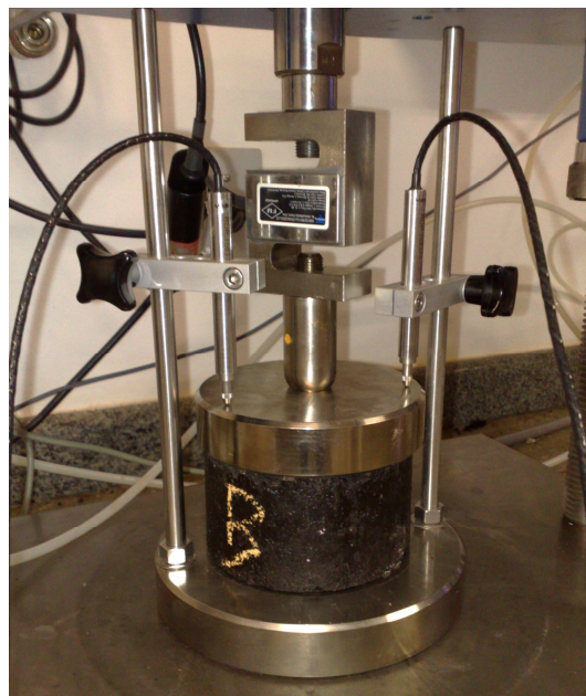
Figura 3.17 Detalhe do posicionamento do pistão e dos LVDTs no corpo de prova.
