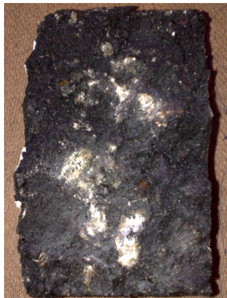
Figura 4.22: CP de CBUQ com agregado granito após a realização do ensaio de RT.
