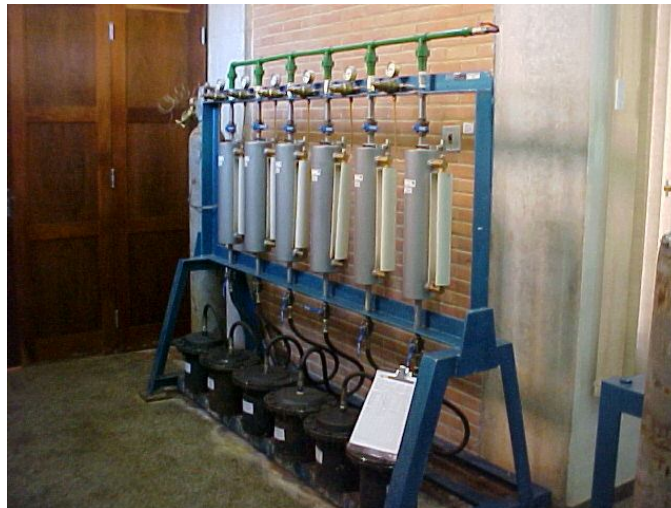
Figura 3.15: Permeâmetro do laboratório de concreto –Furnas (Falcão, 2003).
