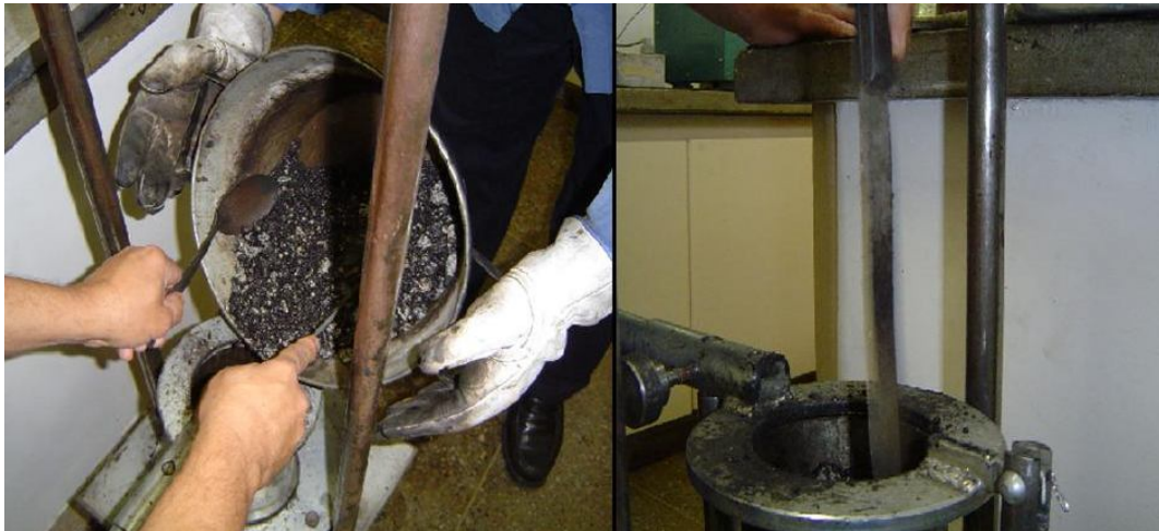
Figura 3.6: Colocação da mistura asfáltica no molde para compactação (Ramos, 2007).
