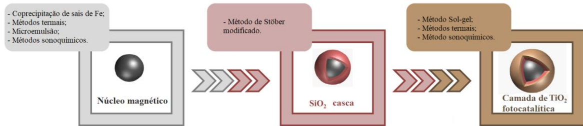
Figura 6: Rotas de síntese para a preparação de nanoestruturas core@SiO 2 @TiO 2 [2].
