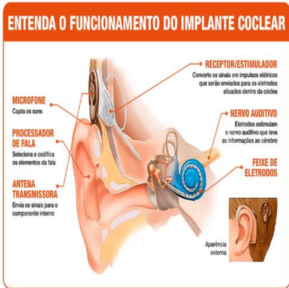
**Figura 1:** Representação esquemática do IC
