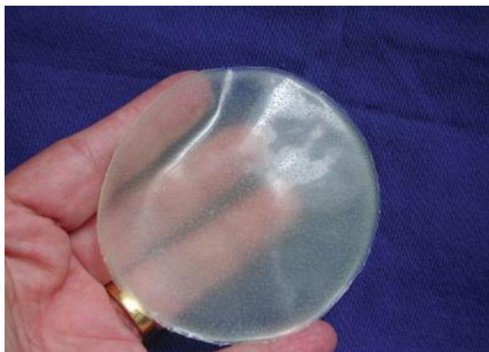
No processo de fabricação dos adesivos, foi necessário que o látex já tenha sido submetido pelo processo de centrifugação a 60%, para diminuir a quantidade de proteínas nele presente naturalmente, muitas delas responsáveis por reações alérgicas. As mesmas exigências valem para as suspensões de enxofre e resina, com o objetivo de conferir ao composto final a elasticidade e a resistência necessárias (MRUÉ, 1996).
