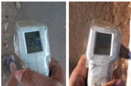
Figura 6: Ensaio de medição utilizando termômetro de temperatura superficial em área sombreada e não sombreada
