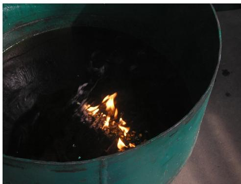
Figura 26: Amostras imediatamente após imersão no meio de têmpera (óleo).
