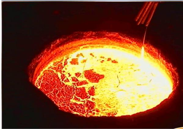
Figura 3: Imagem do aço líquido em um foro panela (Fonte: [www.infomet.com.br](http://www.infomet.com.br), 09/08/2008).
