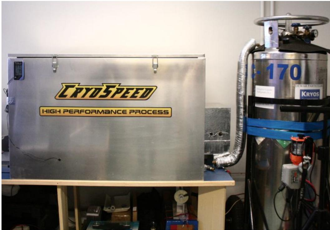
Figura 30: Imagem da câmara de tratamento e do cilindro de armazenamento de nitrogênio líquido da Kryos Tecnologia.
