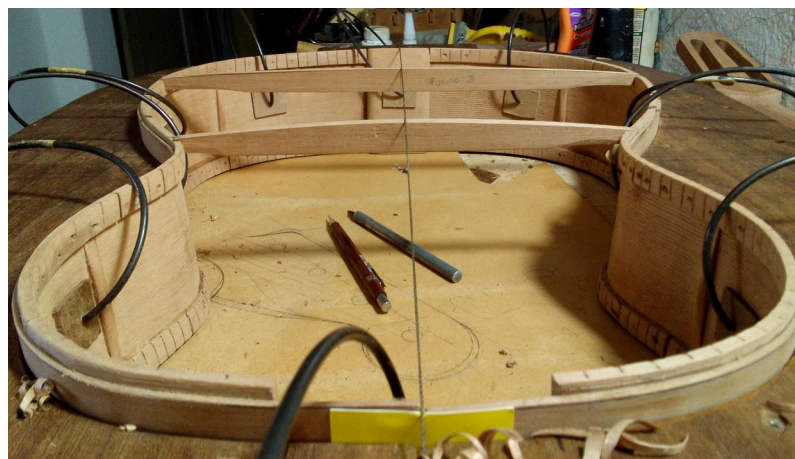
Figura 137: Caixa de ressonância. Processo de construção semelhante a uma casa de madeira. Fonte: ALJ.
