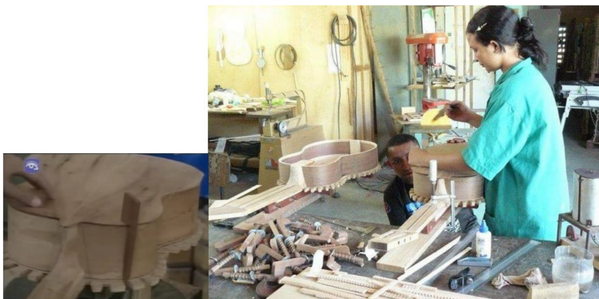
Figura 175: À esquerda, Sandro Hernández utiliza a solera e os grampos de madeira em “L” com molas acopladas para colagem do fundo do violão na Fábrica Fernando Ortiz (Cuba). À direita, Mairis Monteiro e Renato Montalvão montando violões de 6 e 13 cordas na OELA com os mesmos dispositivos desenvolvidos e aplicados por Lage nestes locais. Fonte: CubaInformación e OELA.
