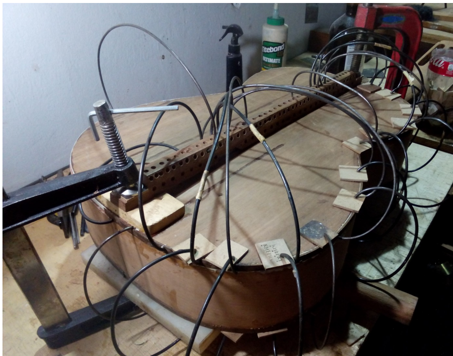
Figura 141: Molas em “C” no processo de colagem de filetes.
