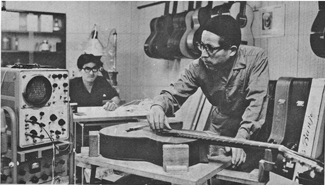
Figura 178: Masaru Kohno avaliando o desempenho acústico de um violão que construiu, utilizando um analisador de espectro sonoro. Tokio: 1949. Fonte: Gendai magazine .
