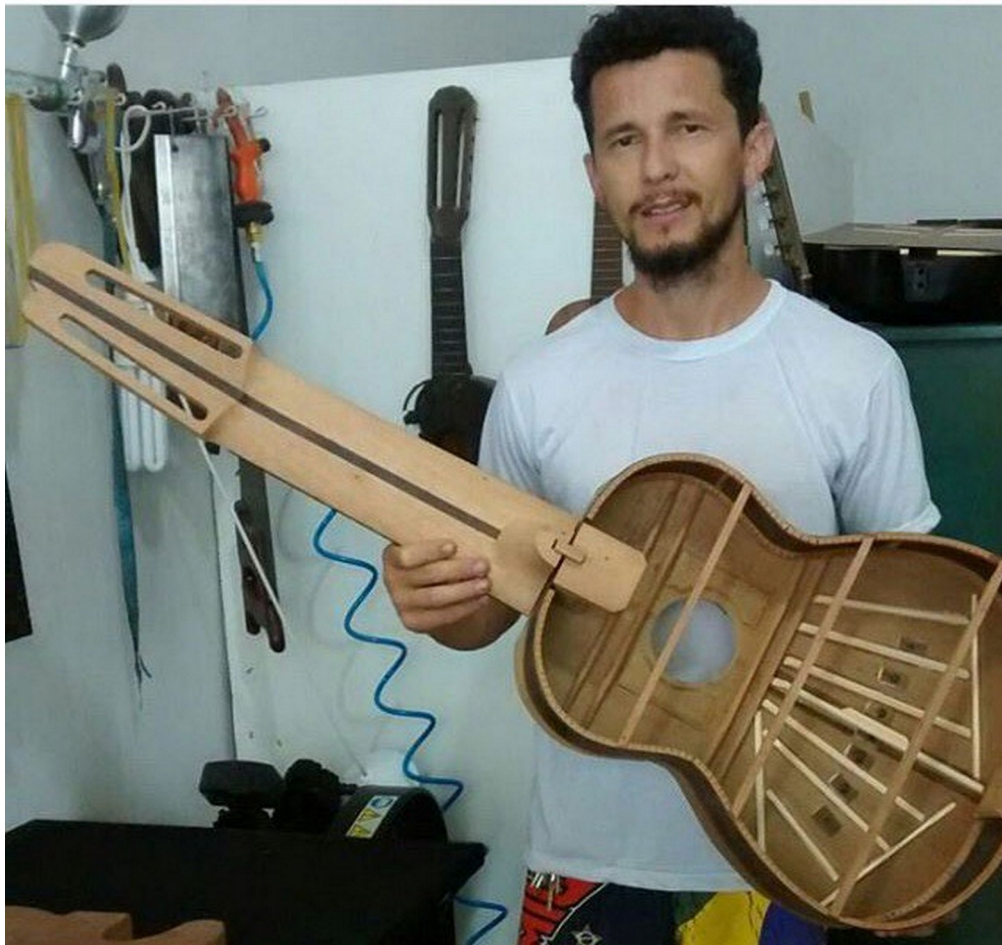
Figura 157: Jêsus Luthieri demonstrando as estruturas internas da caixa de ressonância do violão de 10 cordas Martínez/Luthieri. Fonte: Jêsus Luthieri.
