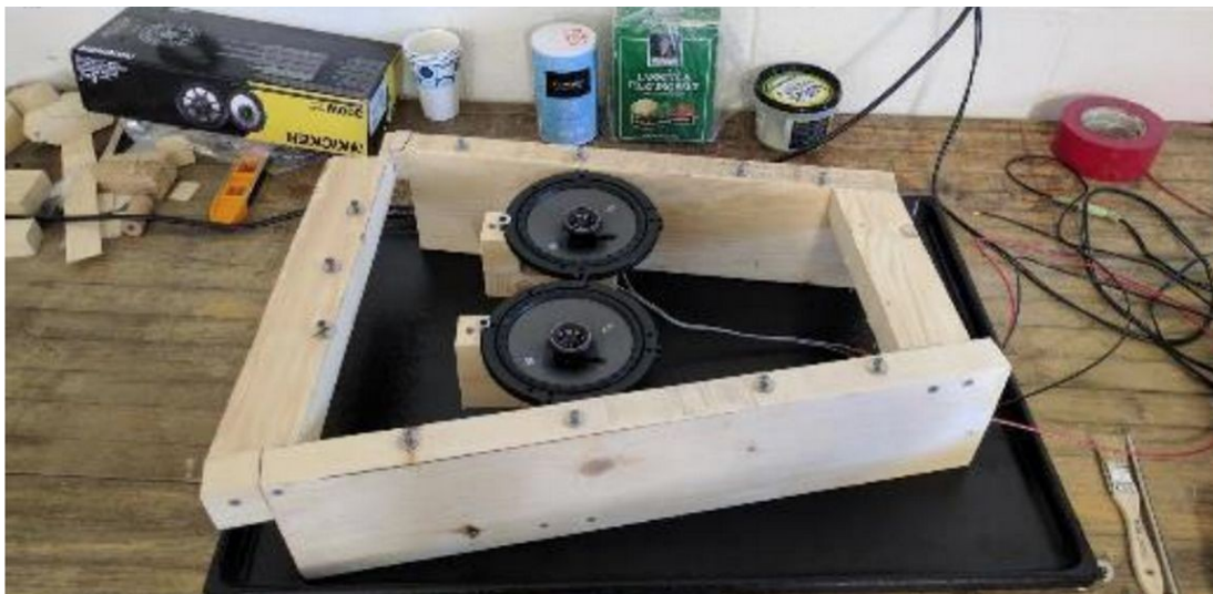
Figura 34: Dispositivo final para teste de Schladni. Fonte: Nicholas et al. 2017, 19.
