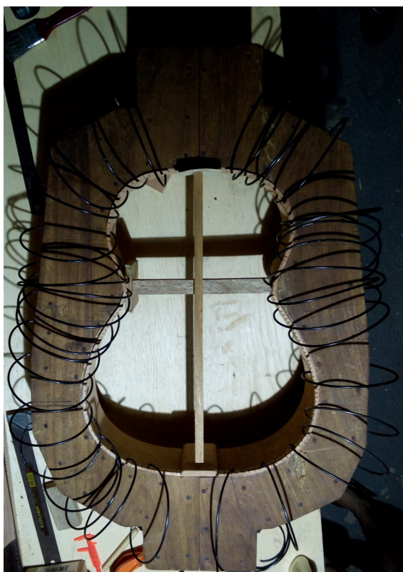
Figura 139: Molas em “C” no processo de colagem do reengrosso. Fonte: ALJ.
