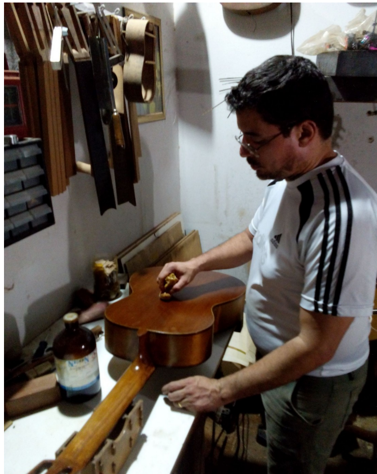
Figura 145: Acabamento. Aplicação de goma laca indiana no tampo, laterais, fundo, braço e voluta. Fonte: ALJ.
