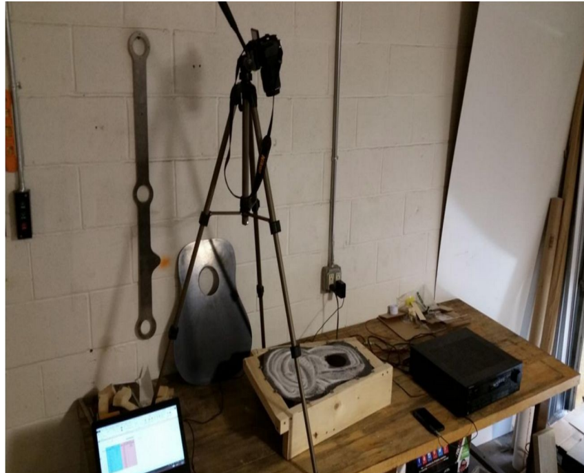
Figura 35: Configuração de teste consistindo de fixador, amplificador, gerador de frequência e câmera para documentar os padrões modais. Fonte: Nicholas et al. 2017, 20.
