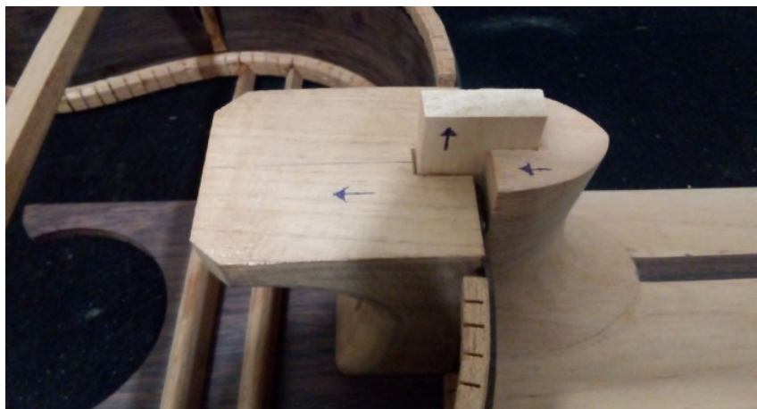
Figura 138: Pilar retangular de conexão entre trócolo interno e externo com corte radial para transmissão das vibrações em cadeia. Fonte: ALJ.
