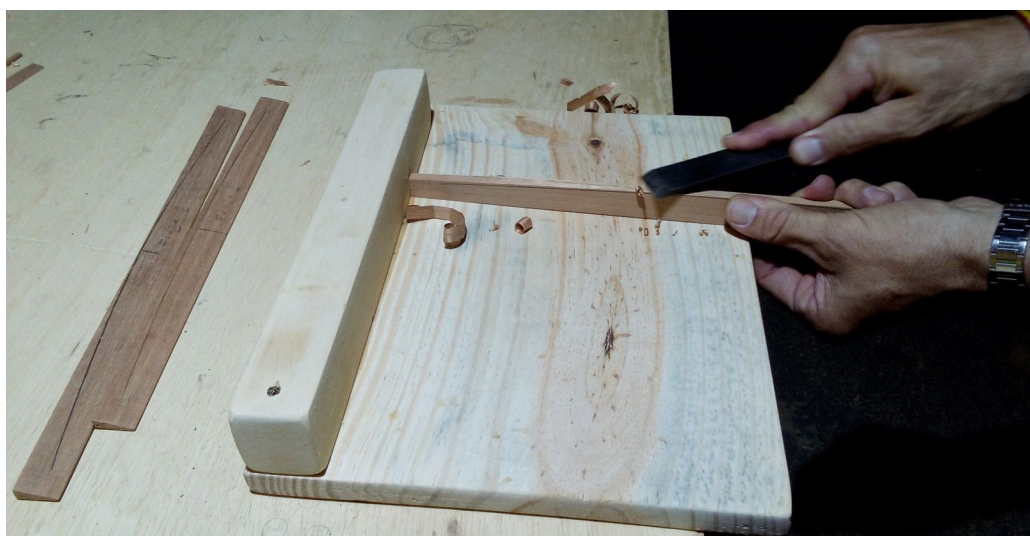
Figura 131: Jêsus Luthieri demonstrando o domínio do formão e a plasticidade coreográfica ao esculpir barras arqueadas para o fundo do violão. Fonte: ALJ.
