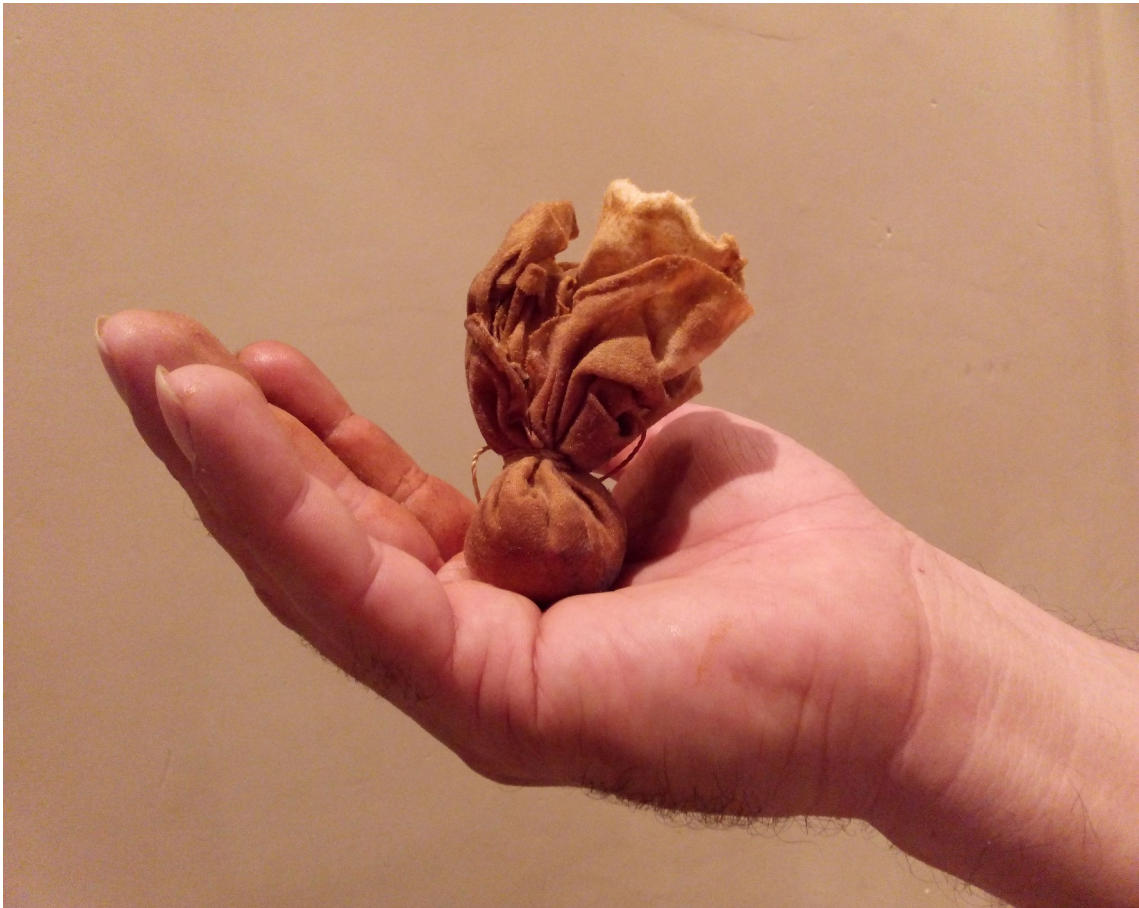
Figura 144: Acabamento. Boneca de pano embebida em goma laca indiana. Fonte: ALJ.
