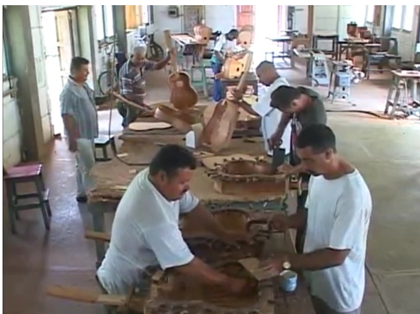
Figura 165: Luthiers cubanos da Fábrica de Violines en Camagüey montando guitarras de estudio com molde tradicional e perfil acoplado em ferro, criado por Raul Lage. Fonte: TV Camagüey .
