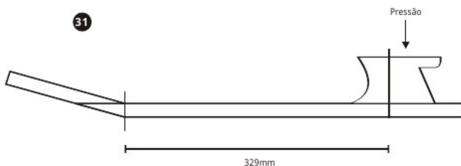
Figura 71: Colagem do bloco de madeira no braço para posterior confecção do salto. Fonte: Gomes et al. 2004, 30.
