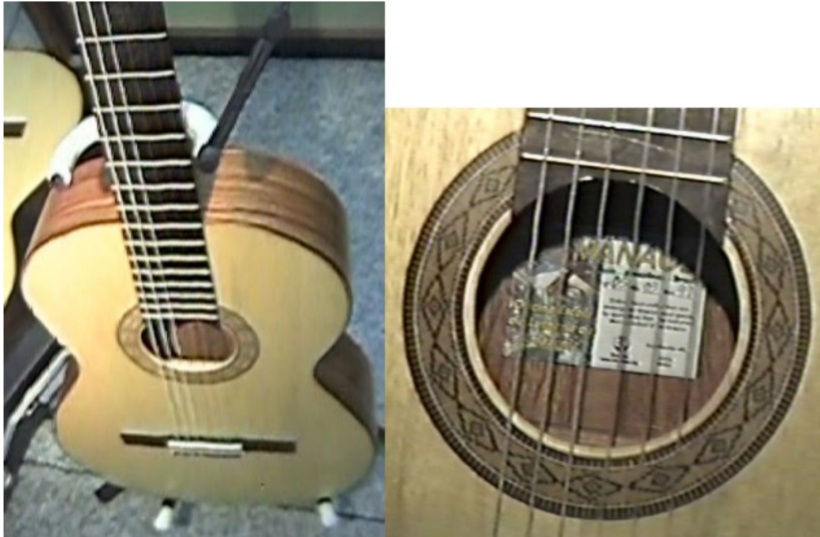
Figura 89: Violão Manaós . Tampo de marupá ( Simarouba amara ), ponte e escala de preciosa ( Aniba canelilla ). Roseta representando as bandeiras que formam a cúpula do Teatro Amazonas. Fonte: ALJ 2000.
