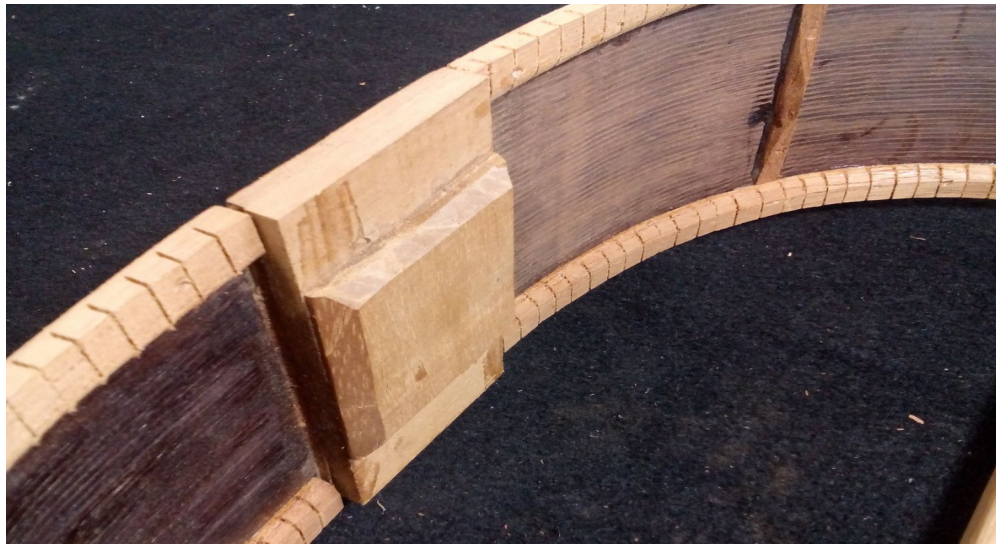
Figura 133: Culatra do violão Martínez/Luthieri 10 cordas. Leveza da forma e o posicionamento de fibras, em sentido longitudinal, com reforço em sentido inverso. Fonte: ALJ.
