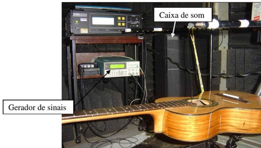
Figura 41: Montagem do aparato instrumental para verificação dos modos de vibração da viola caipira sem corda. Fonte: Paiva 2013, 59.
