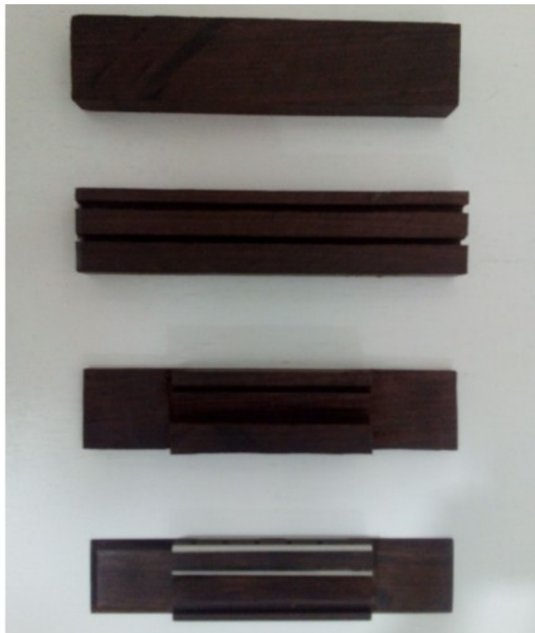
Figura 142: Do paralelepípedo inicial até a forma final do cavalete. Fonte: Luiza Matos
