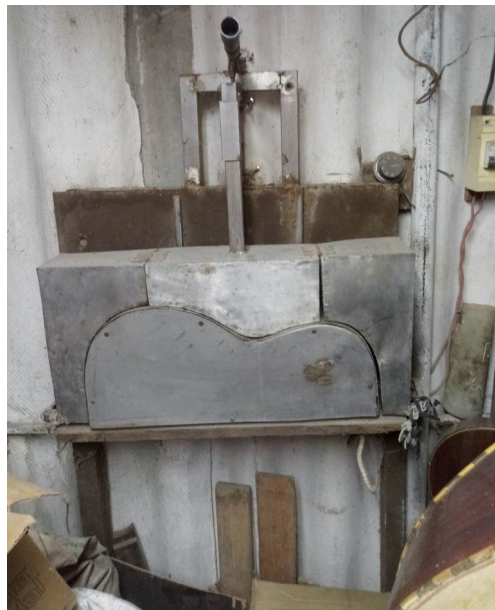
Figura 161: Dobrador de laterais. Modelo de Raul Lage. Fonte: Damarys Romero.
