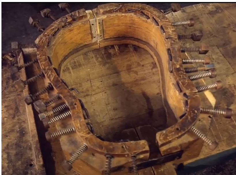
Figura 164: Molde tradicional e perfil com grampos em “L” de ferro e molas acopladas. Fonte: Rodin .
