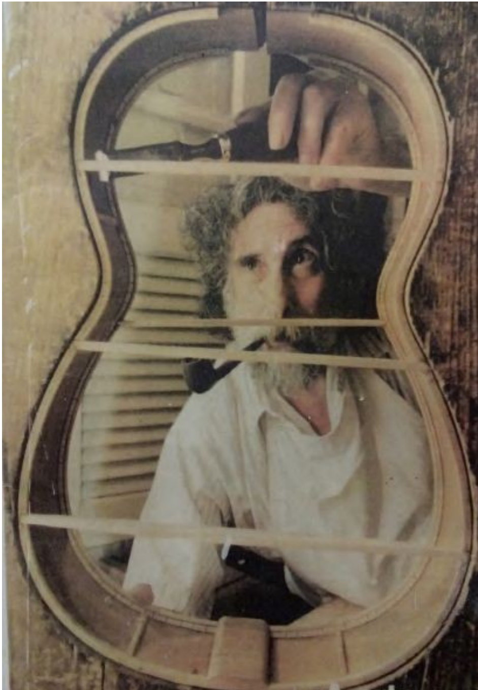
Figura 101: Hugo Martínez desbastando a extremidade da barra do fundo. Fonte: Jornal O Globo. Domingo, 30/10/1994. Fonte: Luiza Matos.
