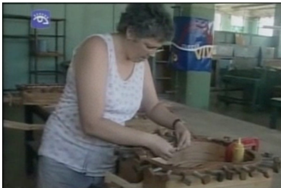
Figura 163: Luthier Damarys Romero demonstrando o perfil com grampos em “L” de ferro e molas de pressão acopladas, para colagem do reengrosso nas laterais. Fonte: TV CubaInformación.
