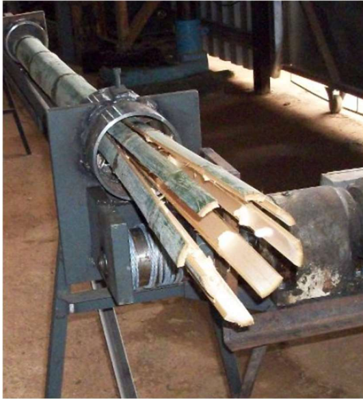
Figura 24 - Máquina para ripamento do bambu
