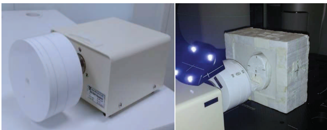
Figura 3.2 – Fantoma respiratório Anzai e junção com o fantoma produzido com caixa refletora (objeto preto com pontos refletores) do RPM.
