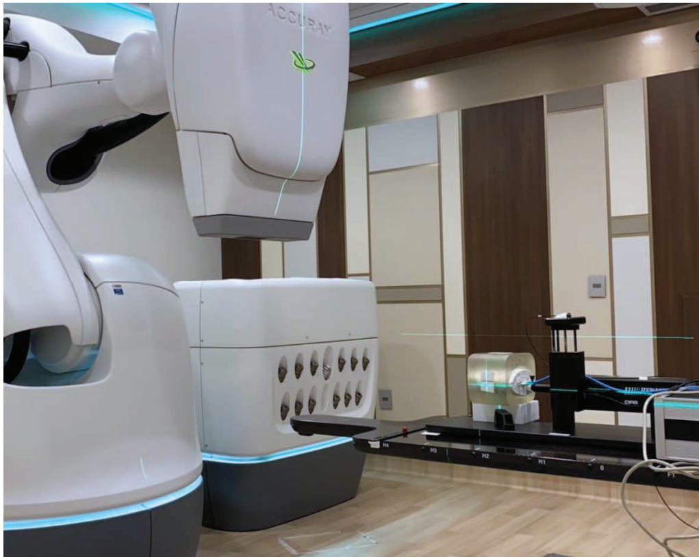
Figura 3.12. Sistema utilizado na medição com fantoma de resina acoplado aos motores do modelo comercial CIRS.
