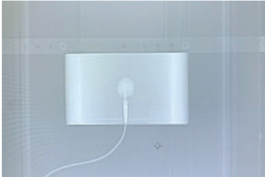
Figura 3.6. Scout tomográfico do fantoma com lesão em lóbulo pulmonar e câmara de ionização posicionada em seu interior.
