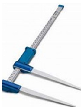
Figura 10. Forcípula y cinta diamétrica.
