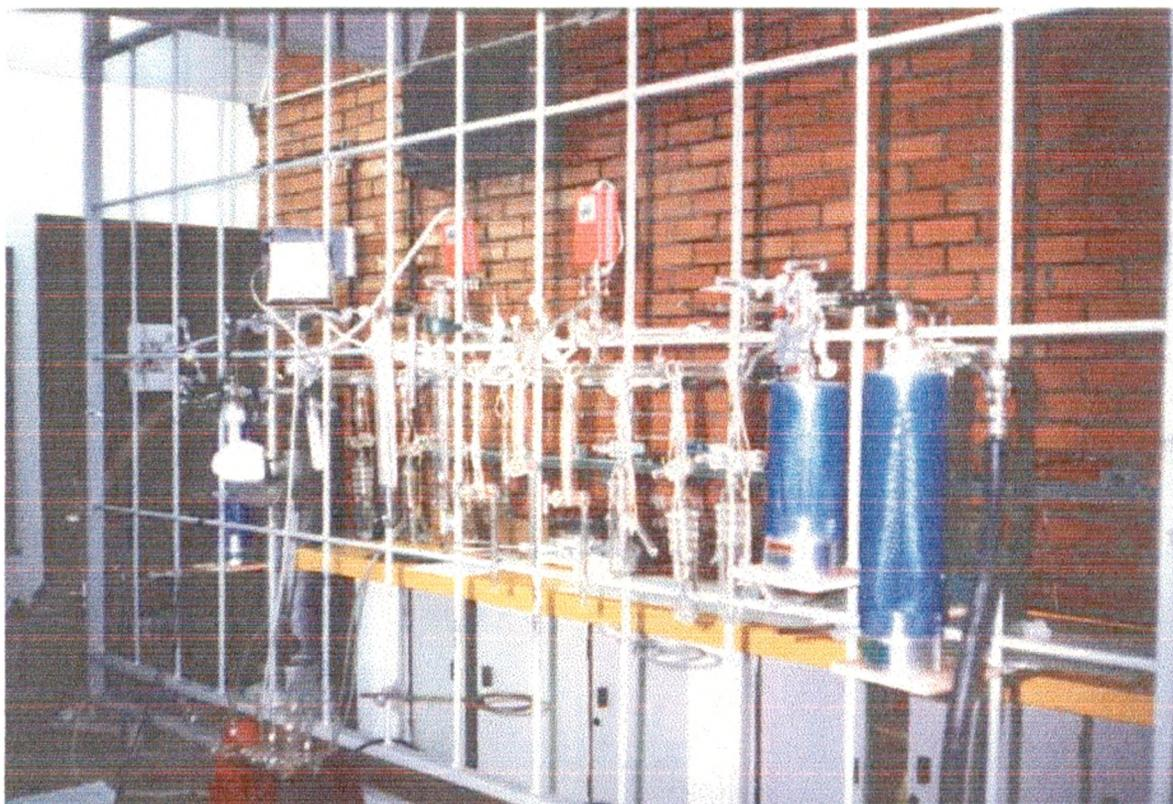
Foto 6-01 Linha de extração de CO<sub>2</sub> montada no LAGEQ/UnB.
