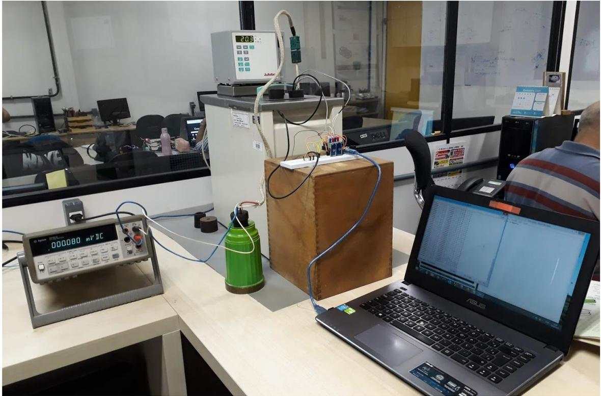
Figura 23 — Calibração dos termopares. Fonte: Elaborada pela autora (2021)
