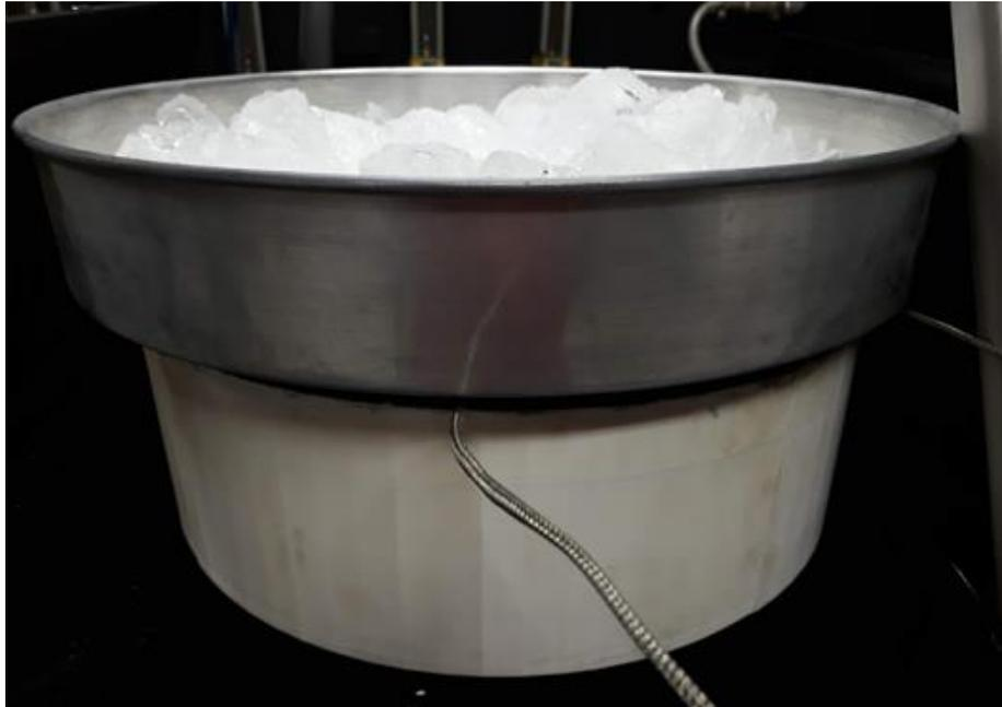
Figura 20 — *Radiation Shield* para aumento do gradiente de temperatura. Fonte: Elaborado pela autora (2021)
