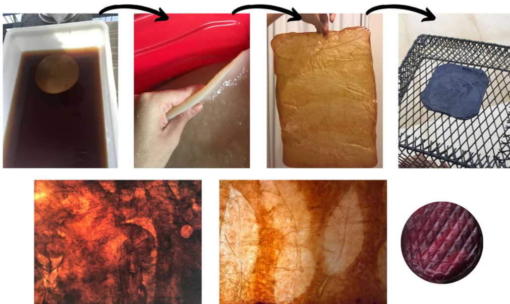
Figura 18. Etapas de desenvolvimento do biomaterial fabricado de kombucha: dentre elas, cultivo em meio de cultura; espessamento; secagem; estamparia. Fonte: Elaboração própria.
