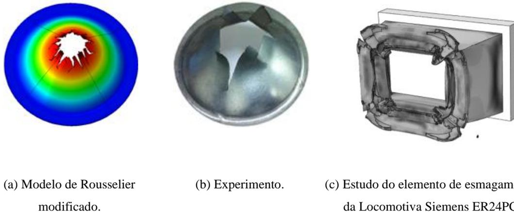
Figura 1-1.(a), (b) Simulação de conformação eletro-hidráulica em chapas de metal DP600 (Fonte: Sarraf e Green, 2018) e (c) Estudo de caso (Fonte: Hosseini Tehrani e Ferestadeh, 2014).
