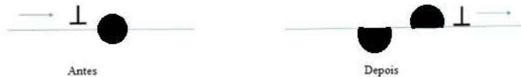
Figura 2.11: Desenho esquemático mostrando o processo de corte dos precipitados mais fracos (Brynjulfsen, 2015 - adaptado).
