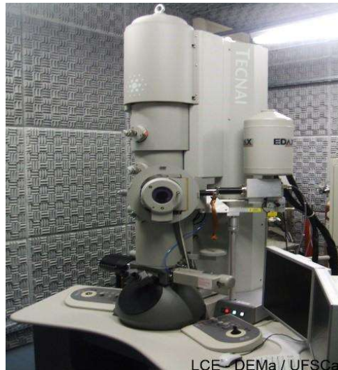
Figura 3.10: Imagem do microscópio eletrônico de transmissão, FEI Tecnai G 2 F20, utilizado para as análises das amostras tratadas termicamente.
