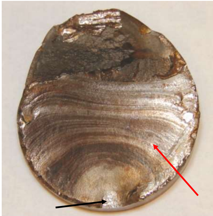
Figura 2.23: Marcas de praia na superfície, indicadas pela seta vermelha. A origem da trinca está indicada pela seta preta (Zolin, 2010 - adaptada).
