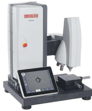
Figura 3.8: Máquina de medição de microdureza Vickers, EmcoTest DuraScan 20, com indentador de diamante e lentes de aproximação de 10x e 40x.
