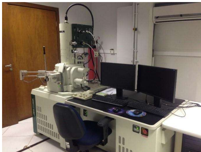
Figura 3.9: Imagem do microscópio eletrônico de varredura, do Grupo de Fadiga Fratura e Materiais, da Universidade de Brasília, da marca JEOL JFM-7100F, utilizado para as análises dos fios fraturados.
