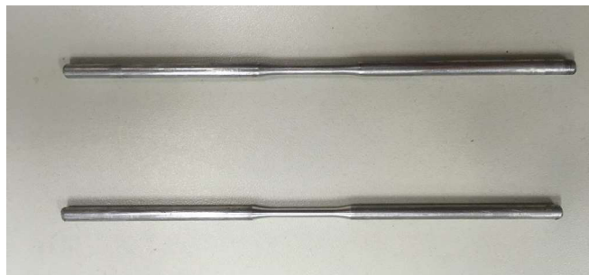
Figura 3.5: Corpo de prova após processo de usinagem, com redução da seção de área transversal.
