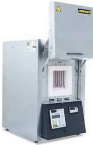
Figura 3.6: Forno Nabertherm com controlador P310, e câmara com dimensões de 150 mm x 150 mm x 150 mm, utilizado para os tratamentos térmicos dos fios do cabo condutor “A”.
