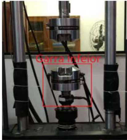
Figura 3.3: (a) Máquina MTS utilizada para o esticamento dos fios e ensaios de tração; (b) Detalhe das garras da máquina, onde os corpos de prova são colocados e as garras os prendem para a realização dos ensaios.
