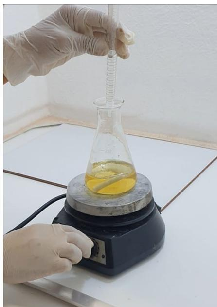
Figura 4.6 - Procedimento de fabricação das nanopartículas de prata.
