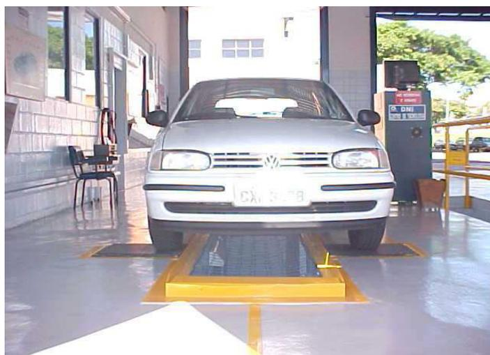
Figura 3.13 – Placas de Verificação de Folgas – DNI/CT/UNICAMP (Novaes, 2006)
