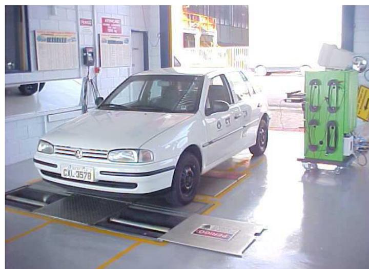
Figura 3.11 – Placas de Verificação da Suspensão – DNI/CT/UNICAMP (Novaes, 2006)
