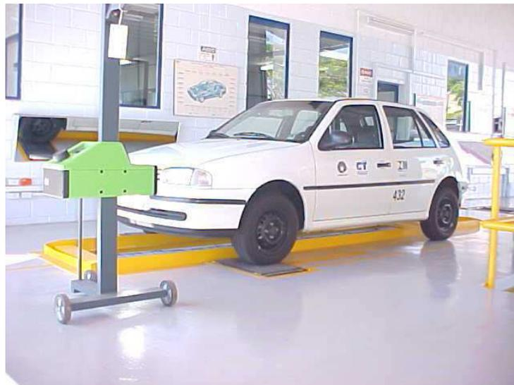
Figura 3.9 – Regloscópio em Uso – DNI/CT/UNICAMP (Novaes, 2006)
