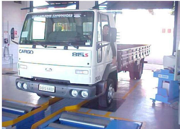
Figura 3.10 – Placa de Verificação do Alinhamento das Rodas – DNI/CT/UNICAMP
