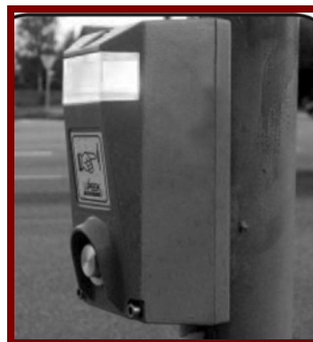
Figura 38: Sinal sonoro e visual que pode ser acionado com o cotovelo. Fonte: Gerente, 2005.
