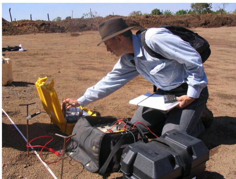
Figura 4.7 – Detalhe do equipamento utilizado para o ensaio geofísico, utilizando-se o arranjo de *Schlumberger*.
