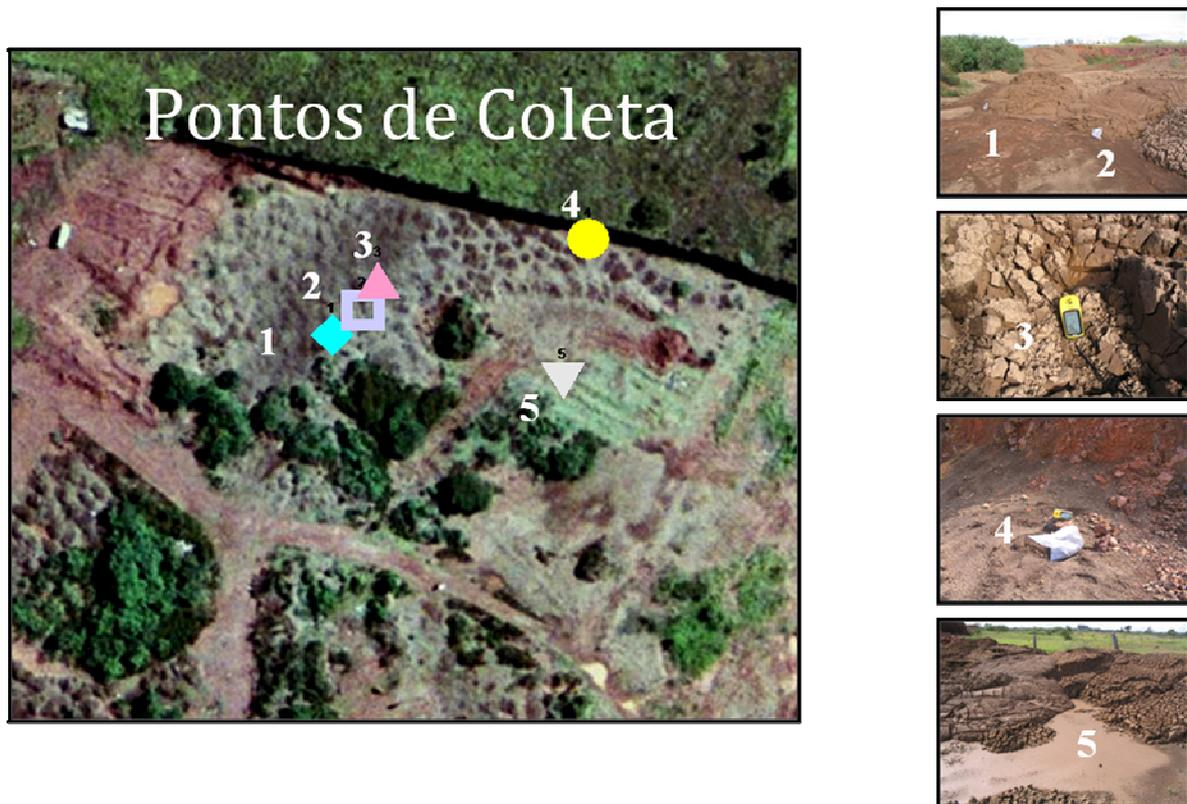
Figura 4.8 – Caracterização preliminar do lodo de estação de tratamento de água disposto na cascalheira. Pontos 1 e 2: lodos recentemente depositados na cascalheira; Ponto 3: lodo desidratado; Ponto 4: lodo desidratado antigo, misturado ao laterito e Ponto 5: material carregado pela chuva.
