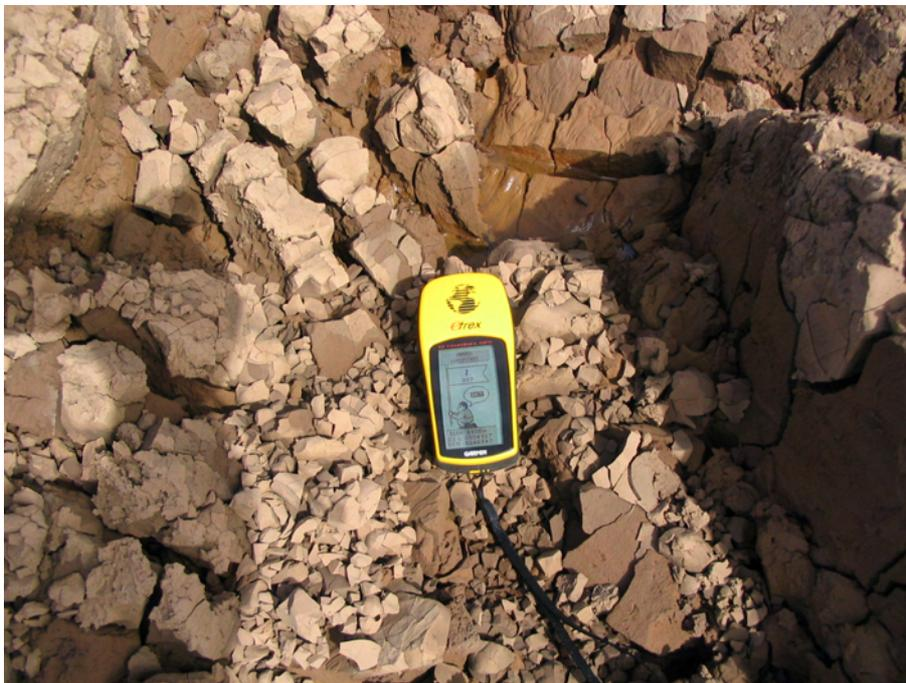
Figura 2.1 – Detalhe das gretas de contração do lodo químico disposto na cascalheira.
