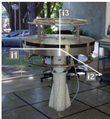
Figura 3.3: Plataforma de testes: mesa giratória de três eixos, (RODRIGUES; MURILO; SOUZA, 2017)
