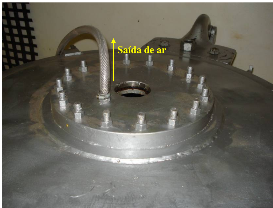
Figura 3.19. Adaptação da tampa do equipamento.
