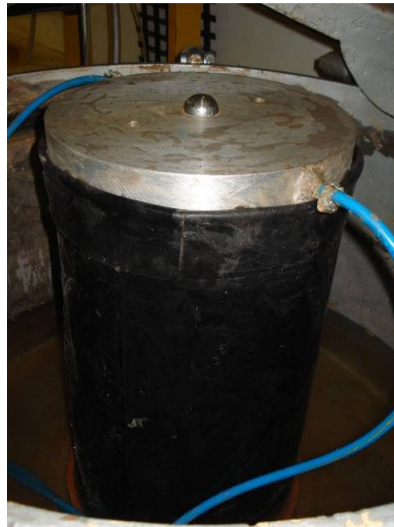
Figura 3.25. Detalhe do corpo-de-prova submetido à aplicação de vácuo.
