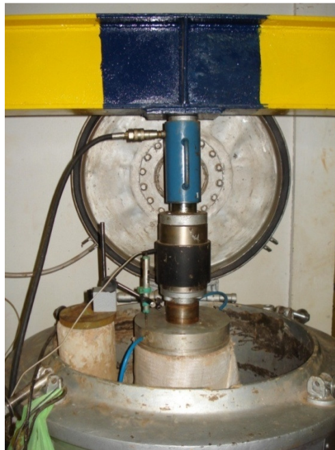
Figura 5.6. Ensaio de compressão simples em amostra de brita encamisada.
