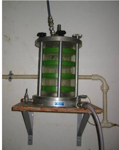
Figura 3.33. Sistema ar/água de aplicação de pressão.
