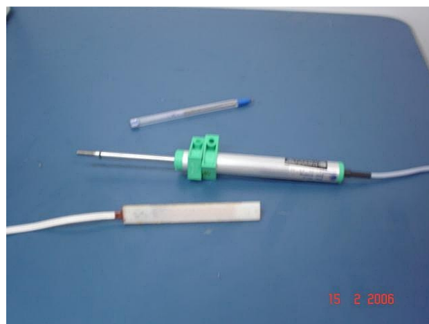
Figura 3.10. Extensômetro e transdutor utilizados nas medições.
