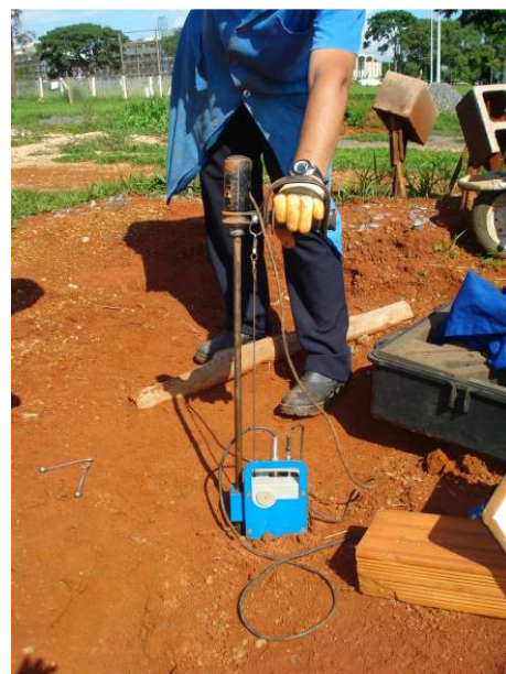
Figura 3.3. Sistema de funcionamento do ensaio PANDA (Modificado - Langdon, 1999).
