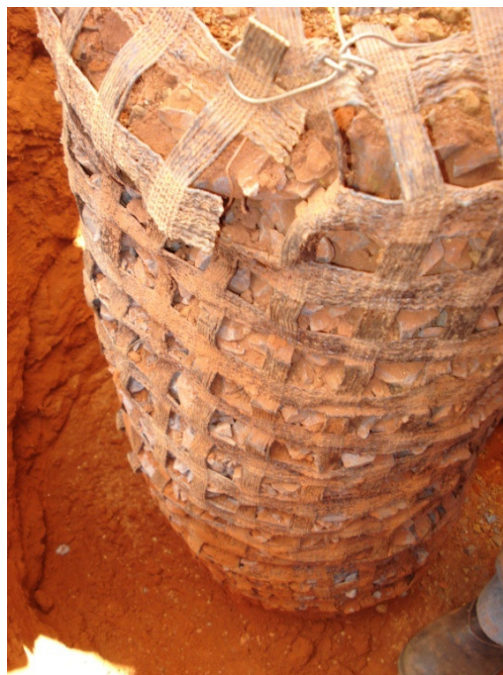
Figura 4.15. Exumação da primeira coluna de brita encamisada.
