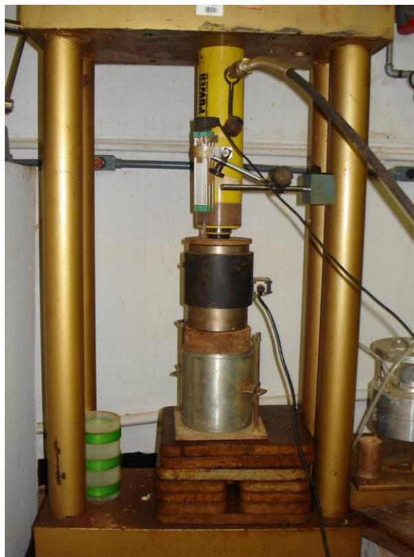
Figura 4.26. Ensaio de compressão oedométrica em cilindro.
