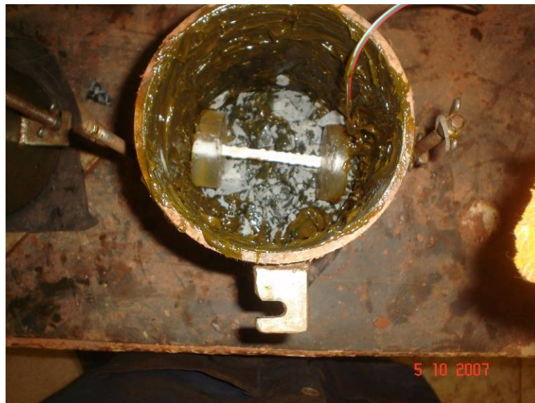
Figura 3.13. Cilindro de C.B.R. untado com graxa e parcialmente preenchido com brita e extensômetro.
