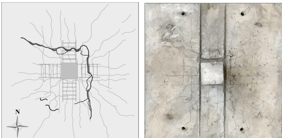
Figura 4.2 – Mapa de fissuração da laje FA-05
