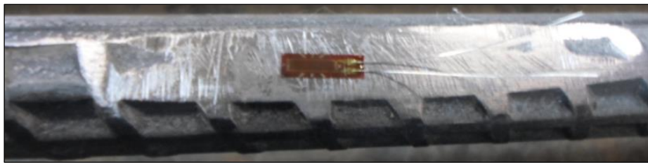
b) Extensômetro colado à armadura
