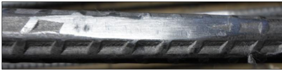
a) Barra depois de limadas, lixadas e limpas
