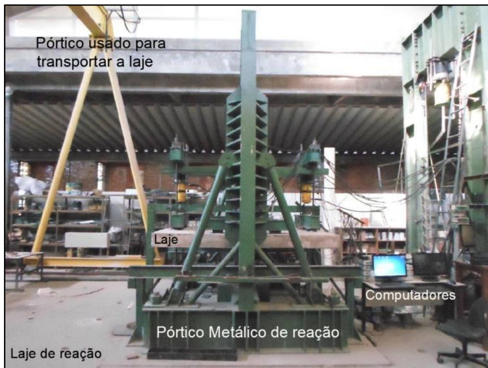
Figura 3.32 - Vista lateral do pórtico de reação
