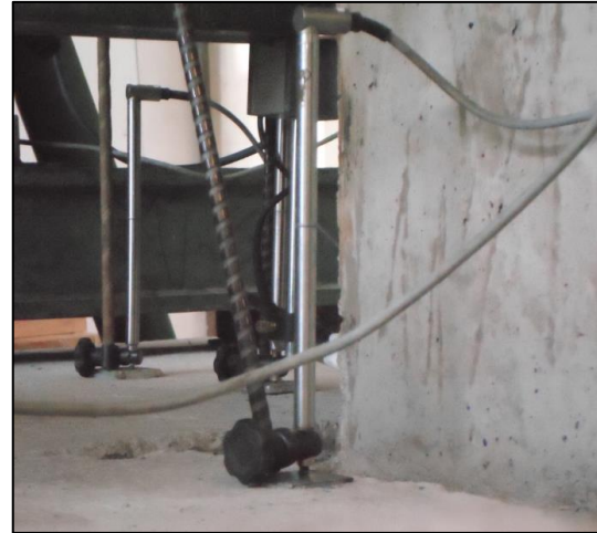
b) LVDT posicionado acima da laje
