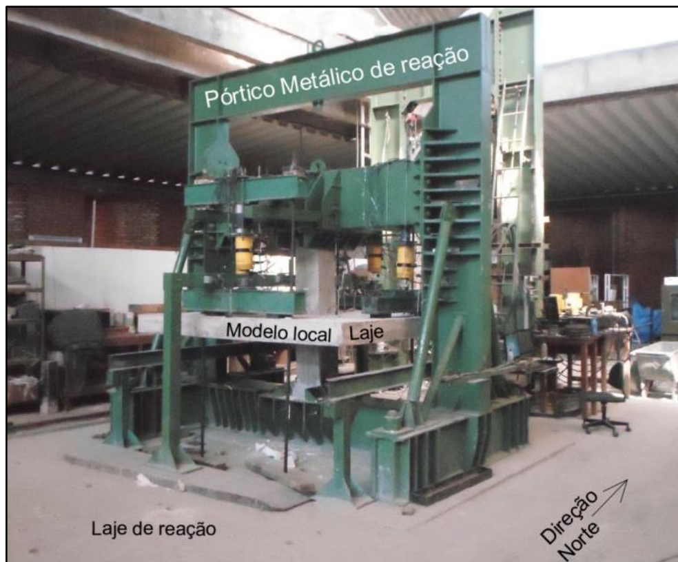
Figura 3.31 - Vista do pórtico metálico de reação
