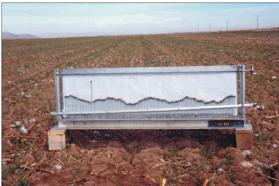
Figura 3.6 – Fotografia de campo mostrando um aparelho (rugosímetro) para medir a rugosidade do terreno. A fotografia mostra a rugosidade sobre um terreno com sulcos de plantio, numa área agrícola com restos de cultura de algodão em Phoenix, Arizona. Foto: Edson Sano.
