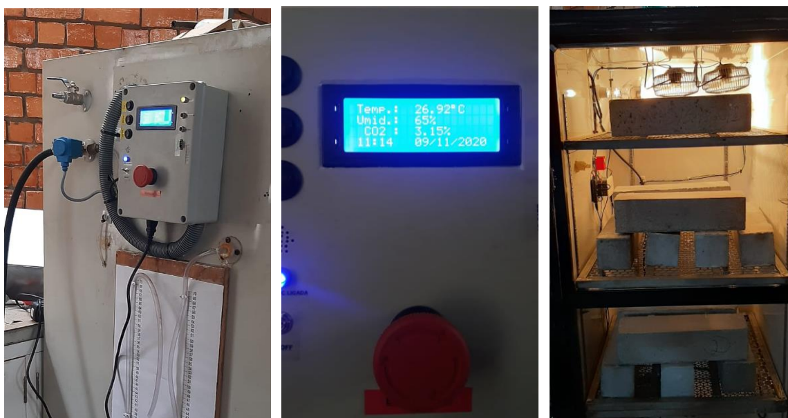
Figura 3.23 - Câmara de carbonatação utilizada no ensaio.
