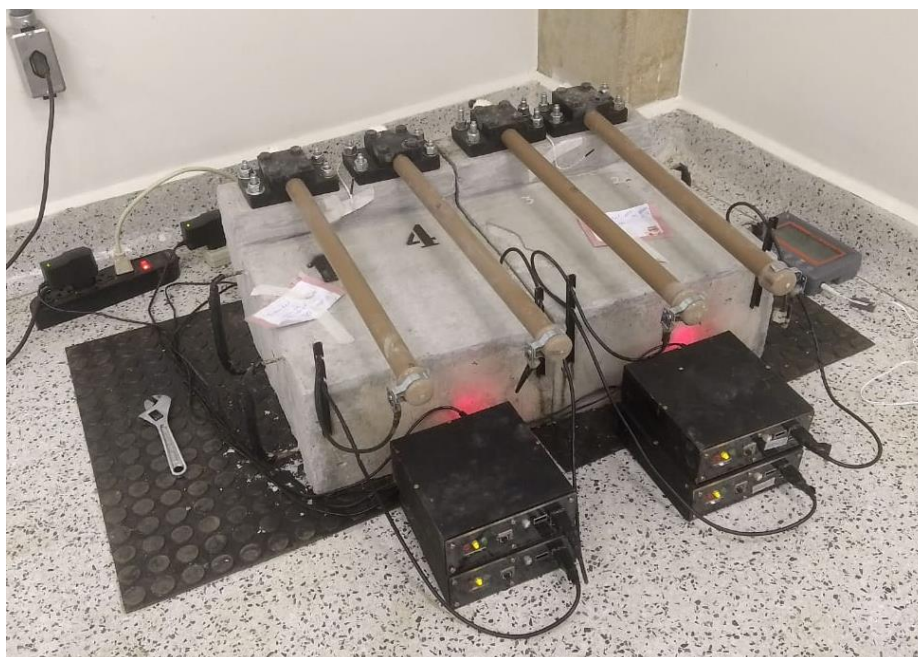
Figura 3.11 – Ensaio EMM-ARM em andamento.
