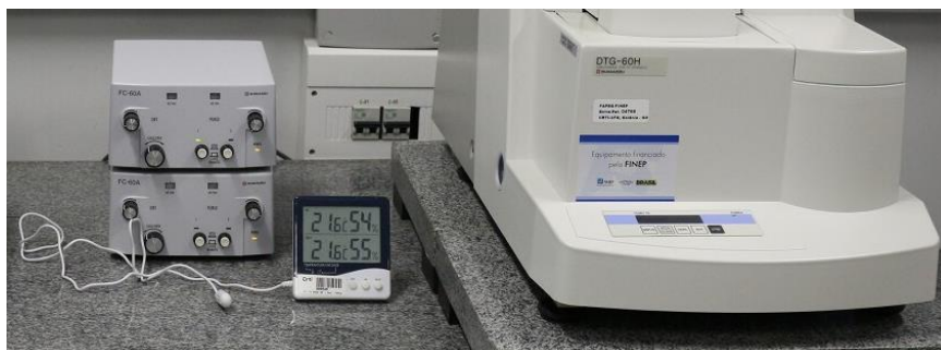
Figura 3.29 – Equipamento utilizado para a realização do ensaio de TG
