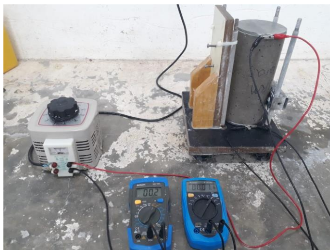
Figura 3.20 - Ensaio de resistividade elétrica volumétrica em andamento
