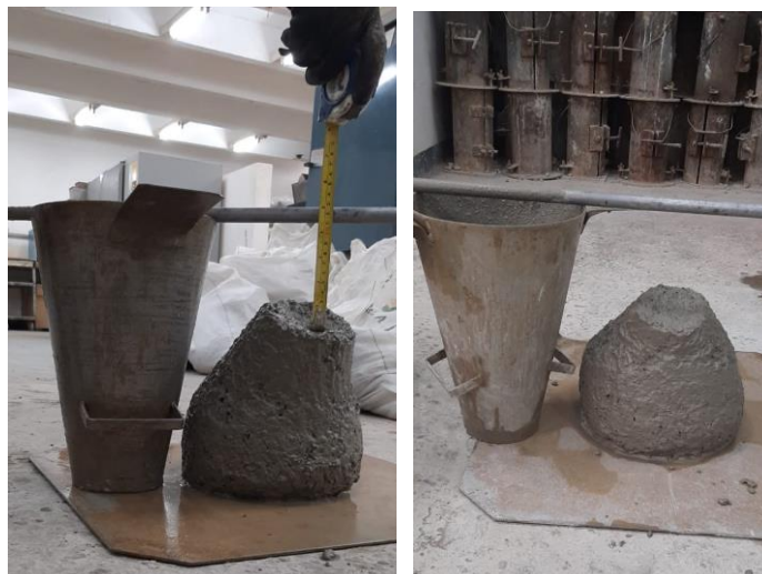
Figura 4.8 - Ensaio de consistência pelo abatimento do tronco de cone.
