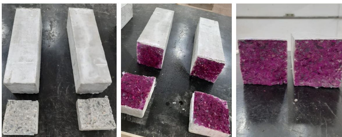
Figura 3.24 - Corpo de prova antes e após aplicação de fenolftaleína em idade de 56 dias
