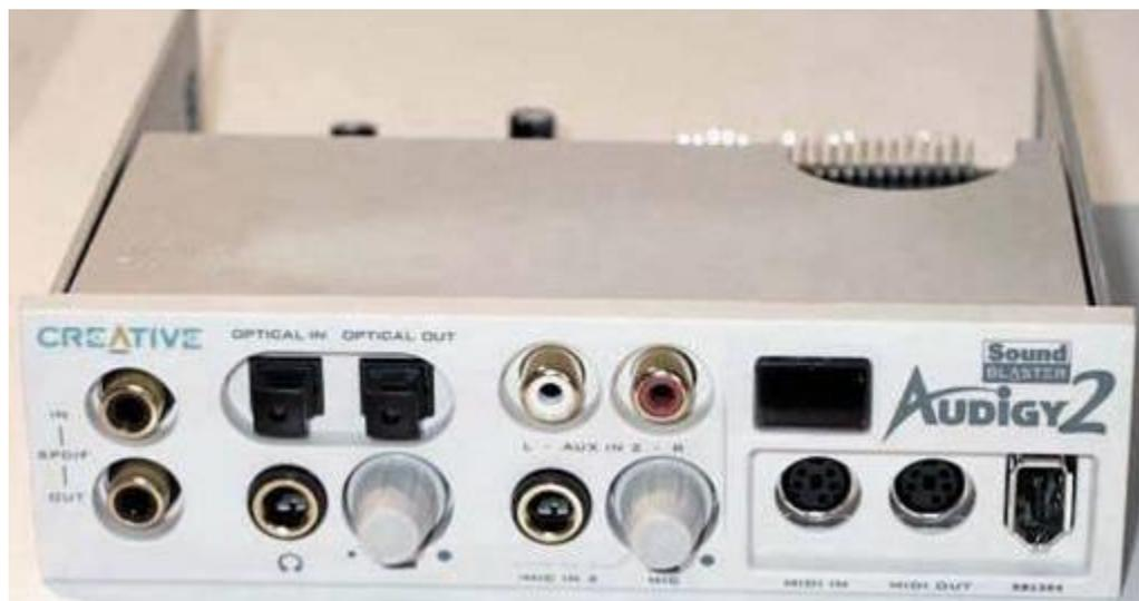
**Figura 44.** Interfaz externa de Tarjeta de Sonido tipo PCI, Audigy2 de la Línea Sound Blaster de Creative Labs. <http://www.anycpu.com/projects/diypc/GraniteBay/SoundCard.htm>, Anycpu (Doan M. Guyen y Jürgen Failenschmid), Acc. Abril 28 2020.
