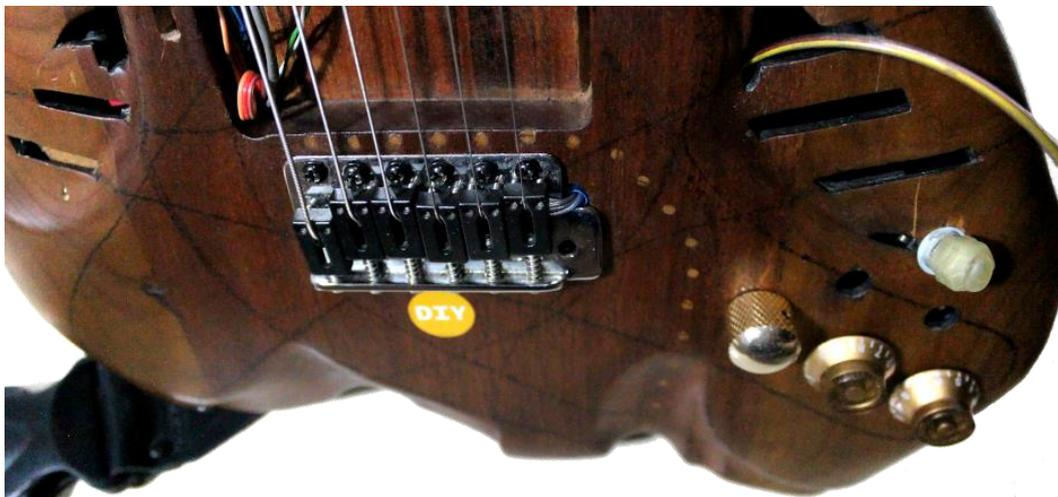
*Figura 18. «Palito-Elefante» en el año 2015, puente metálico con saddles de polímero, Leandro M. 2015*
