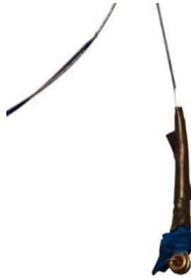
*Figura 17. Solución fallida de aislamiento: termo-encogible + cinta aislante. Sobreviviente de hace años. Leandro M. jun. 2020*
