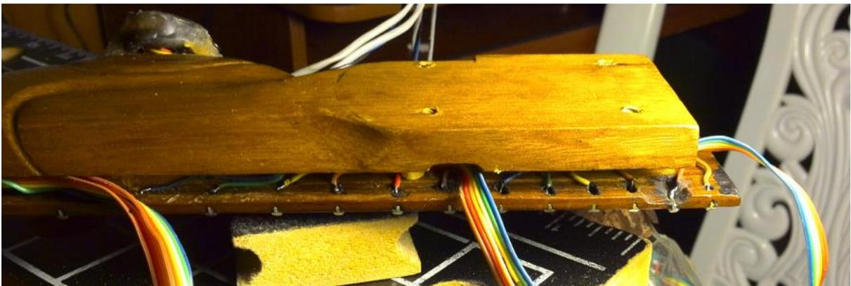
*Figura 12. Brazo desmontado de «palito-elefante», con lateral abierta mostrando capas de cable, y soldaduras, Leandro M. 2016*
