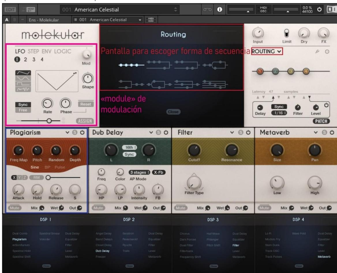
Figura 54. Montaje de GUIs de MOLEKULAR, mostrando los efectos disponibles por cada DSP, y la pantalla de «Routing» en «preset» American Celestial. Ene. 2021, Leandro M.
