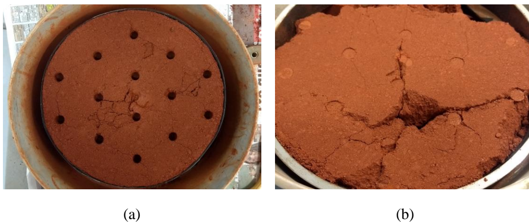
Figura 5.60. Camada de distribuição diâmetro inclusão 38.1 cm após ensaio: (a) D1H3SN, (b) D1H1SC
