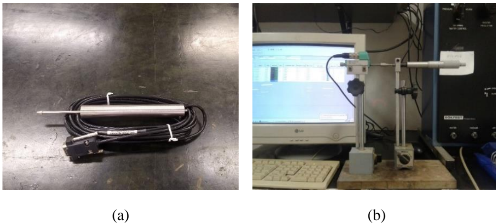
Figura 4.6. Transdutores de deslocamento linear LVDT: (a) Transdutor de deslocamento TD-50. (b) Processo de calibração
