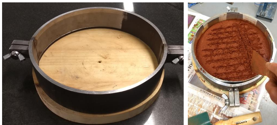
Figura 5.15. Molde de compactação: (a) molde bipartido, e (b) processo de escarificação
