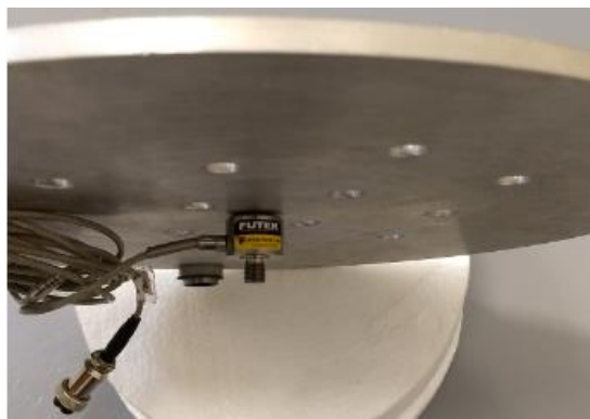
Figura 5.10. Célula de carga Futek LCM 325 instalada na placa móvel
