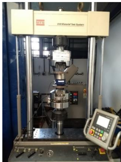
Figura 4.8. Procedimento calibração células de carga
