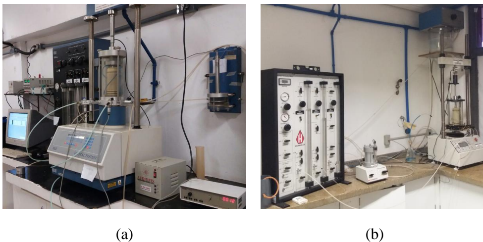
Figura 3.3. Equipamento triaxial a) ELE TRITEST 50 laboratório geotécnia UnB, e b)Humbolt HM 3000 Infralab UnB
