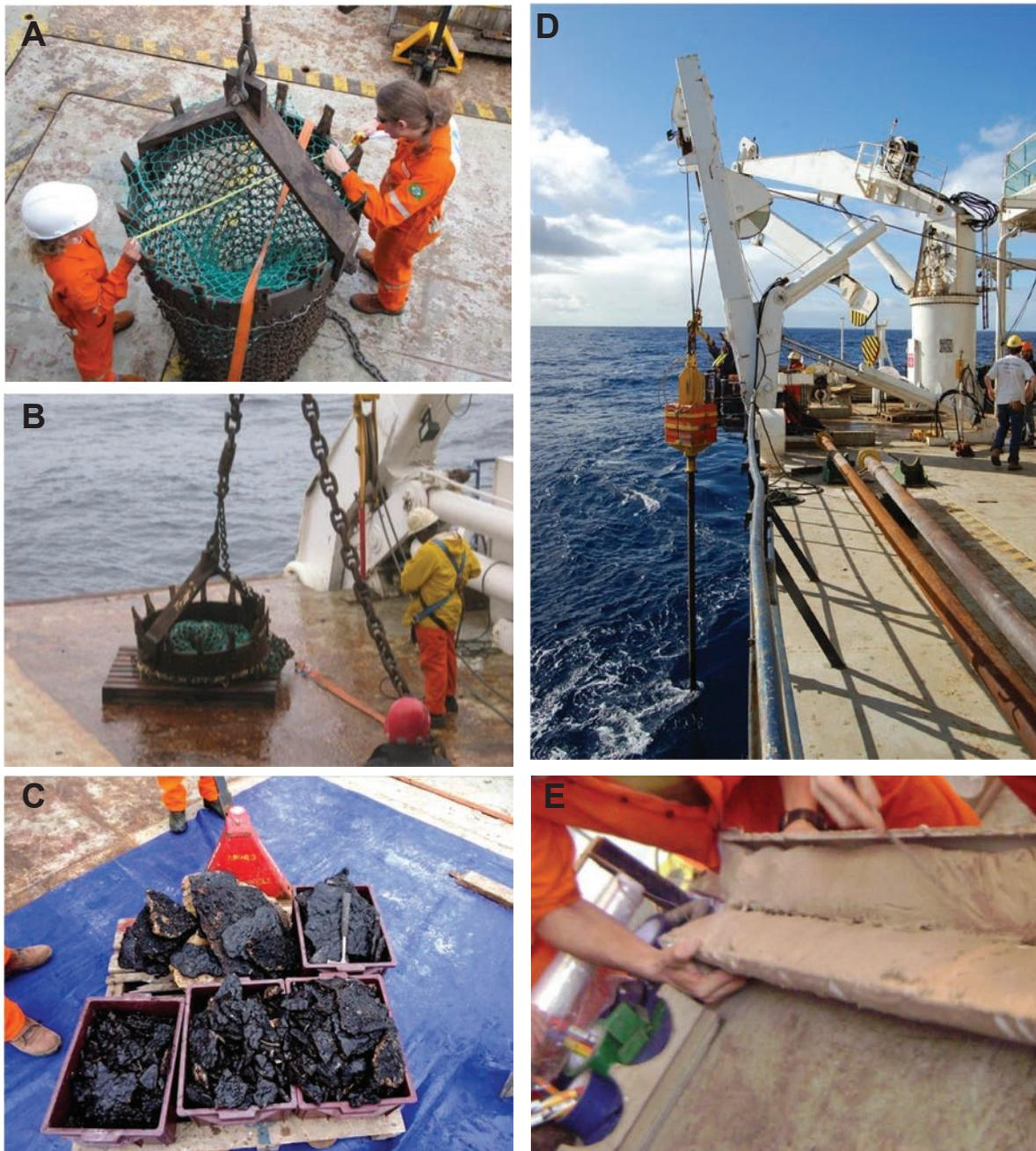
Figura 3-1: A e B. Draga circular utilizada na coleta de crostas ferromanganesíferas; C. Crostas ferromanganesíferas, D. *Piston Corer* CALYPSO; E. Testemunho de perfuração por sítio core. Fonte: CPRM.
